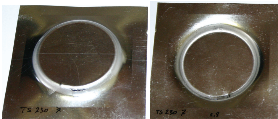
Slika 8.16 Uzorak TS230 - 7, kut 60° visina 7 mm
