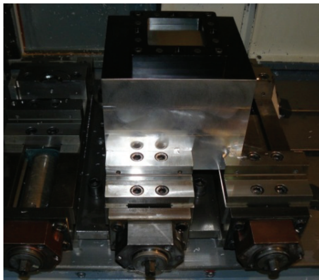
Slika 8.5 Prikaz radne naprave stegnute u škripce
