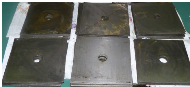
Slika 5.18 Pripremljene podložne ploče, materijal DC01 debljine 1 mm
