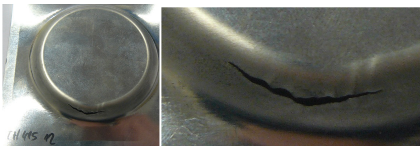
Slika 10.14 Popuštanje materijala pri hladnoj obradi na 10 mm visine
