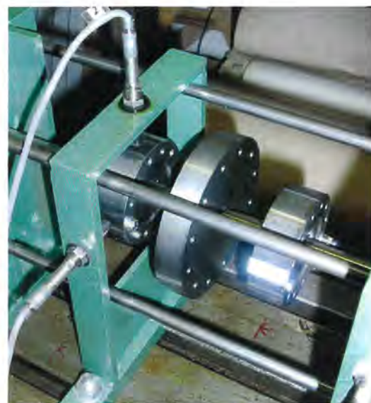
Slika 5.4. Raspored diskova na osovini
