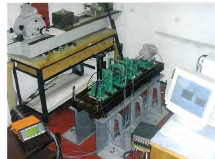
Slika 5.2. Fotografija eksperimentalnog uređaja za istraživanje dinamike rotora
