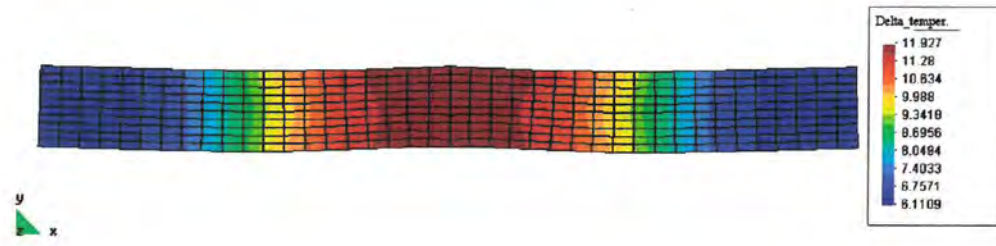
Sl. 8.39. Porast temperature na kraju procesa deformiranja
