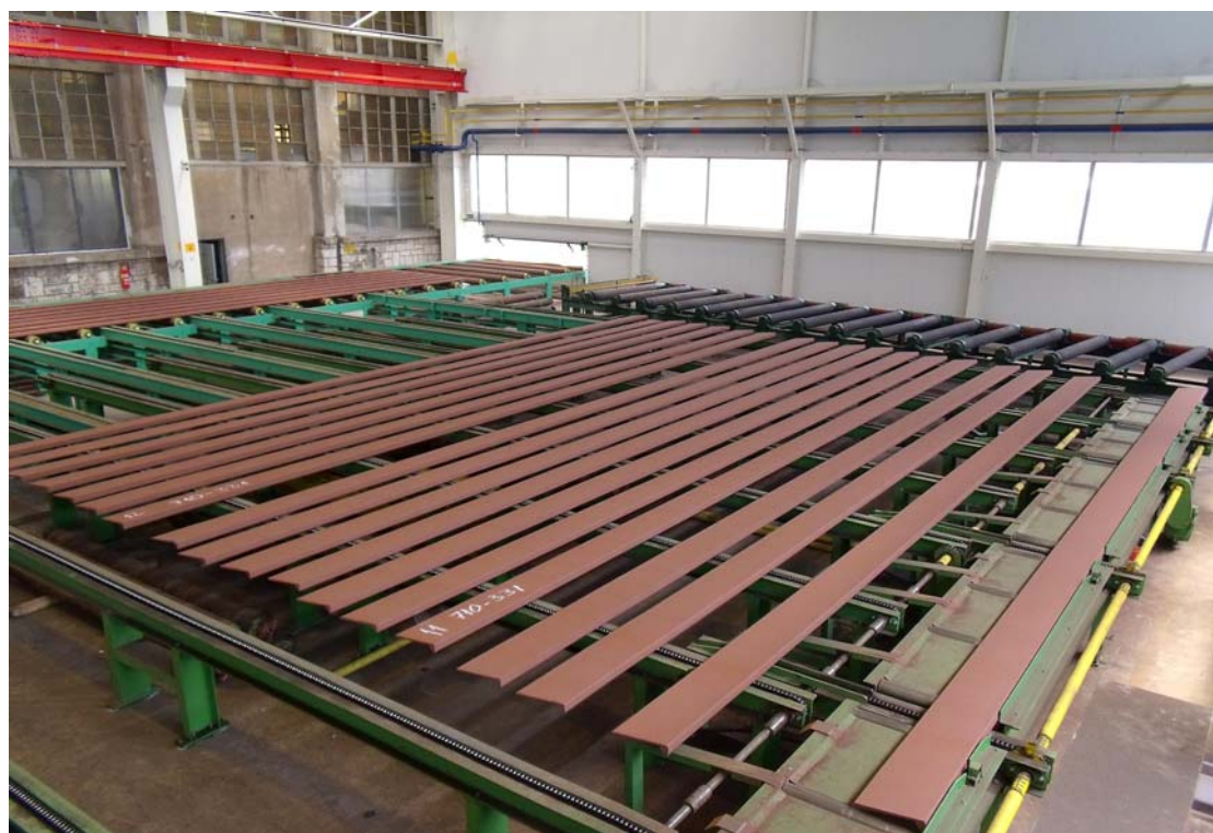
Slika P5.2 Prikaz dijela linije na kojoj se vide bankate profila na ulaznom međuskладиštu prije pojedinačnog prelaska na uzdužni valjčasti transporter
