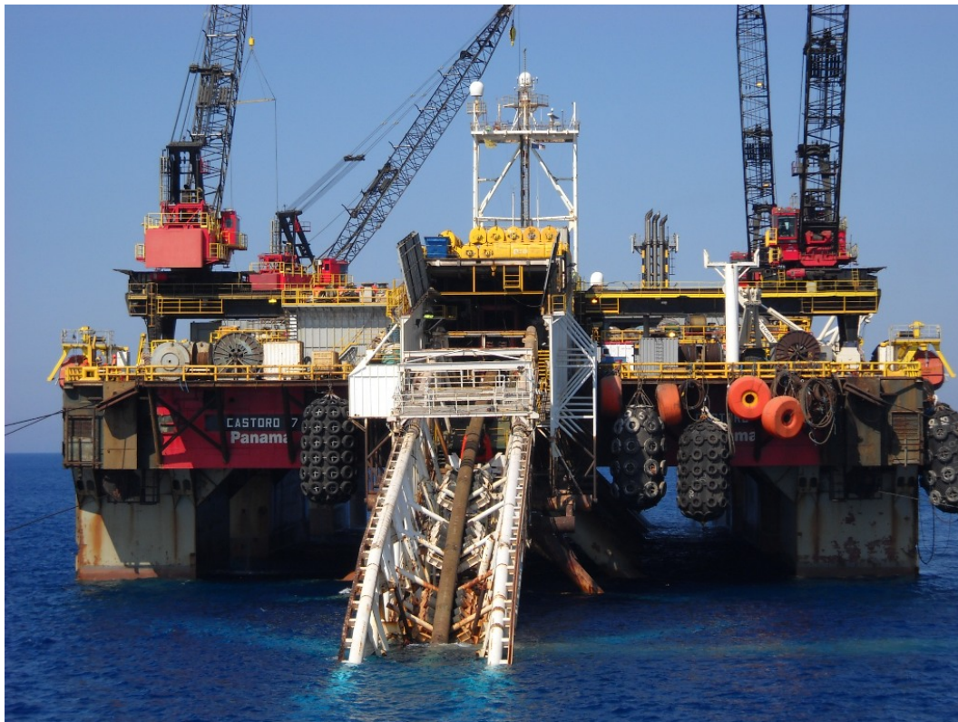
Slika 1.3: Polaganje podmorskih cjevovoda S-Lay metodom
