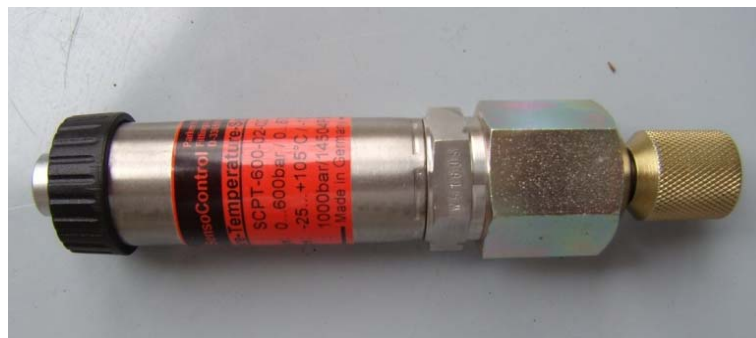
Slika 5.8. Mjerni osjetnik tlaka i temperature SCPT 600-02-20
