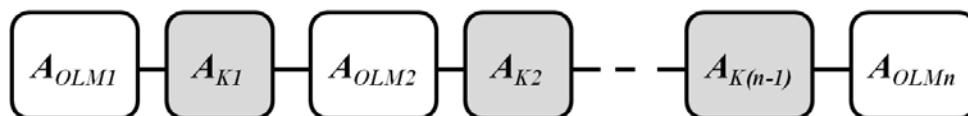
Slika 75: Model raspoloživosti serijske strukture sa n OLM elemenata i (n-1) kabelskih sekcija
