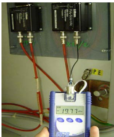
Slika 65: Mjerenje snage svjetlosnog signala
