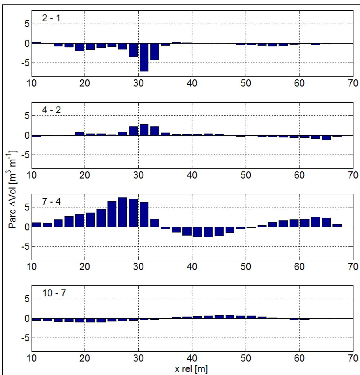
**Slika 7.5. Parcijalne promjene volumena uzduž žala [ $m^3 m^{-1}$ ]. A - otvaranje žala: 1 (2.1.) – 2 (5.1.), B - spori oporavak žala: 2 (5.1.) – 4 (24.1.), C - brzi oporavak žala: 4 (20.1.) – 7 (14.2.), D - bez značajnih promjena 7 (14.2.) – 10 (11.4.)**
