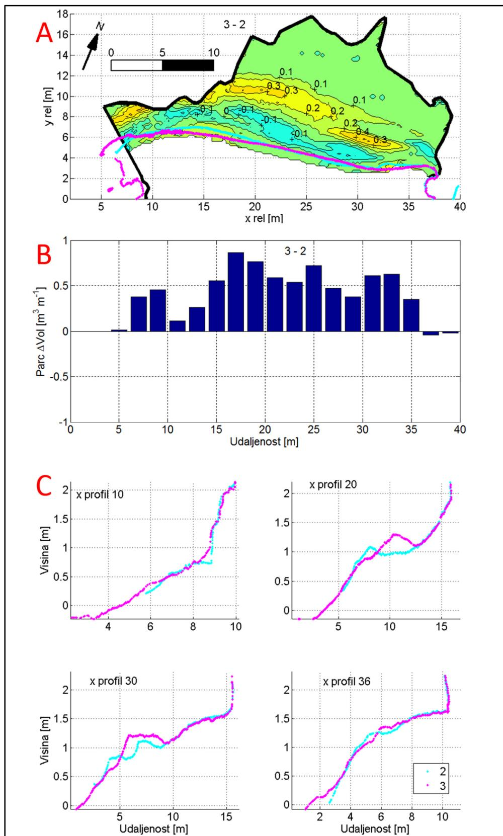
Slika 6.15. Promjene žala Klančac između mjerjenja br. 2 (30.10.) i 3 (6.11.). A - promjene visina žala; B - parcijalne promjene volumena žala; C - promjene poprečnih presjeka žala
