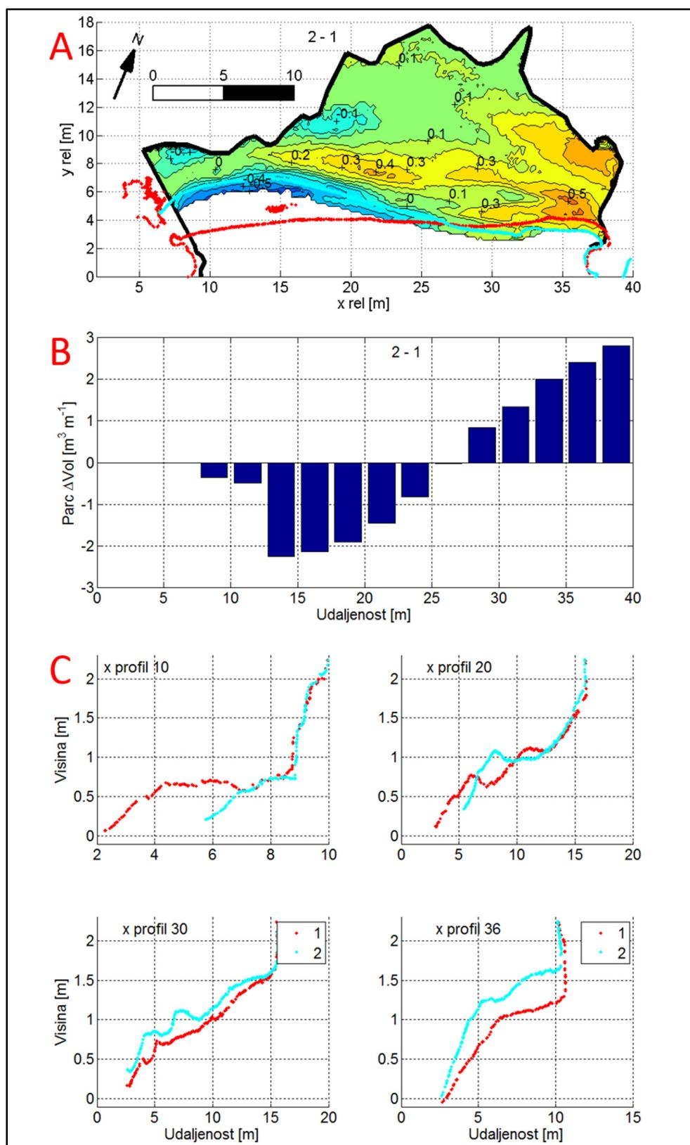
Slika 6.13. Promjene žala Klančac između mjerena br. 1 (4.10.) i 2 (30.10.). A - promjene visina žala; B - parcijalne promjene volumena žala; C - poprečni presjeci žala
