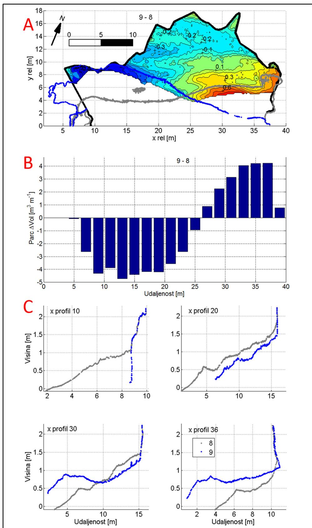
Slika 6.27. Promjene žala Klančac između mjerena 8 (24.12.) i 9 (27.12.). A - promjene visina žala; B - parcijalne promjene volumena žala; C - poprečni presjeci žala
