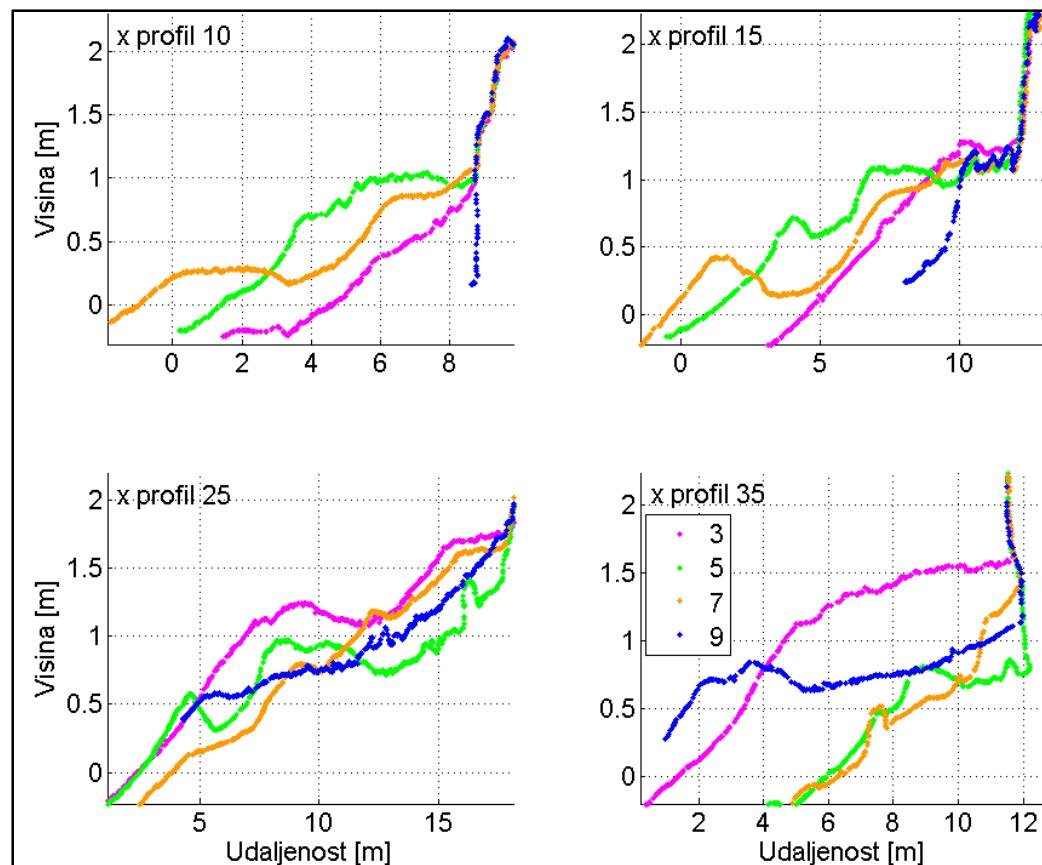
**Slika 6.28. Promjene poprečnih presjeka profila 10, 15, 25 i 35 od mjerena br. 3 (6.11.) do 9 (27.12.)**
