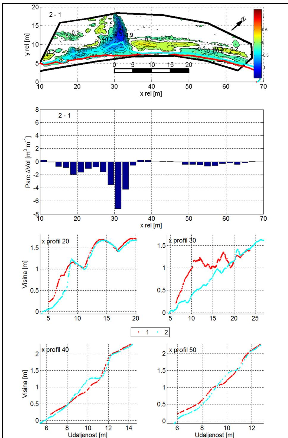
**Slika 7.6. Promjene žala Uboka između mjerjenja br. 1 (2.1.) i 2 (5.1.)** A - promjene visina žala; B - parcijalne promjene volumena žala; C - poprečni presjeci žala
