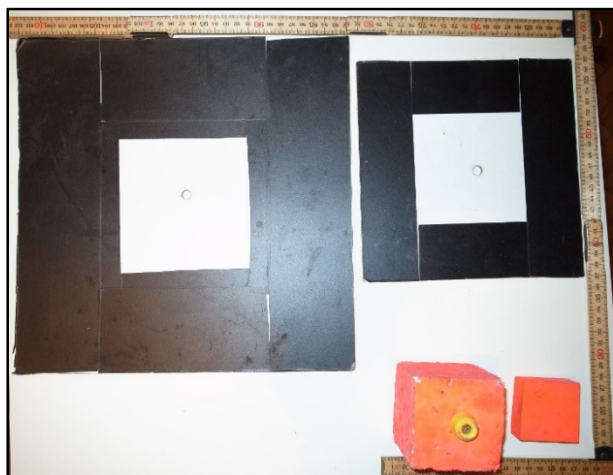
Slika 5.4. Primjer korištenih zemaljskih kontrolnih točaka ( ground-control-points (GCP) )
