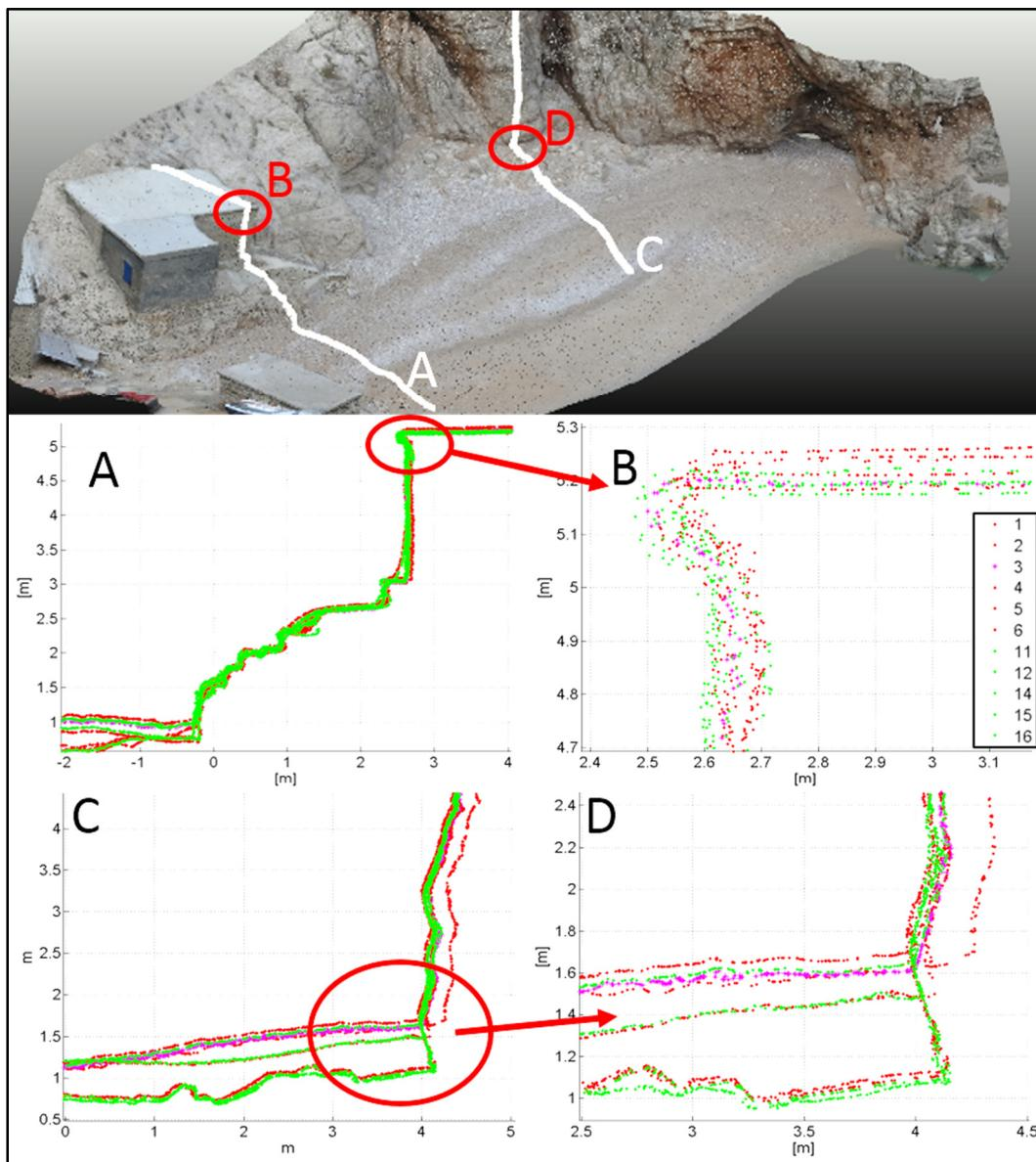
**Slika 5.12. Poprečni presjeci derivirani iz oblaka točaka prije (crveno) i nakon (zeleno) primjene ICP algoritma u odnosu na referentno mjerena broj 3 (ljubičasta). A – poprečni presjek sa prikazanim detaljem na objektu (B); C – poprečni presjek s prikazanim detaljem na granici stijene i žala (D)**
