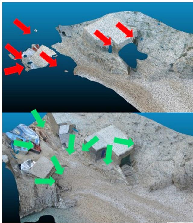
**Slika 5.3. Trodimenzionalni oblaci točaka žala Klančac, snimljeni 30.10.2013. (crvena) i 18.11.2013. (zelena).** Strelicama su prikazane pojednostavljene pozicije i kutovi snimanja fotografija
