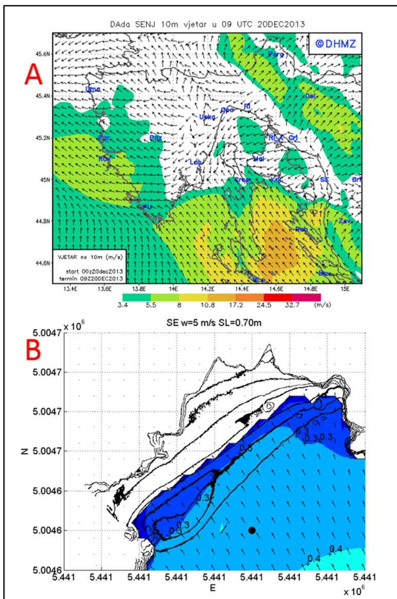
**Slika 6.23. Polje vjetra prognozirano modelom Aladin (A - 20.12). Rezultati numeričke simulacije značajne visine vala (SWAN) ispred žala Klančac sa prikazanim slojnicama mjerena 7 i 8**
