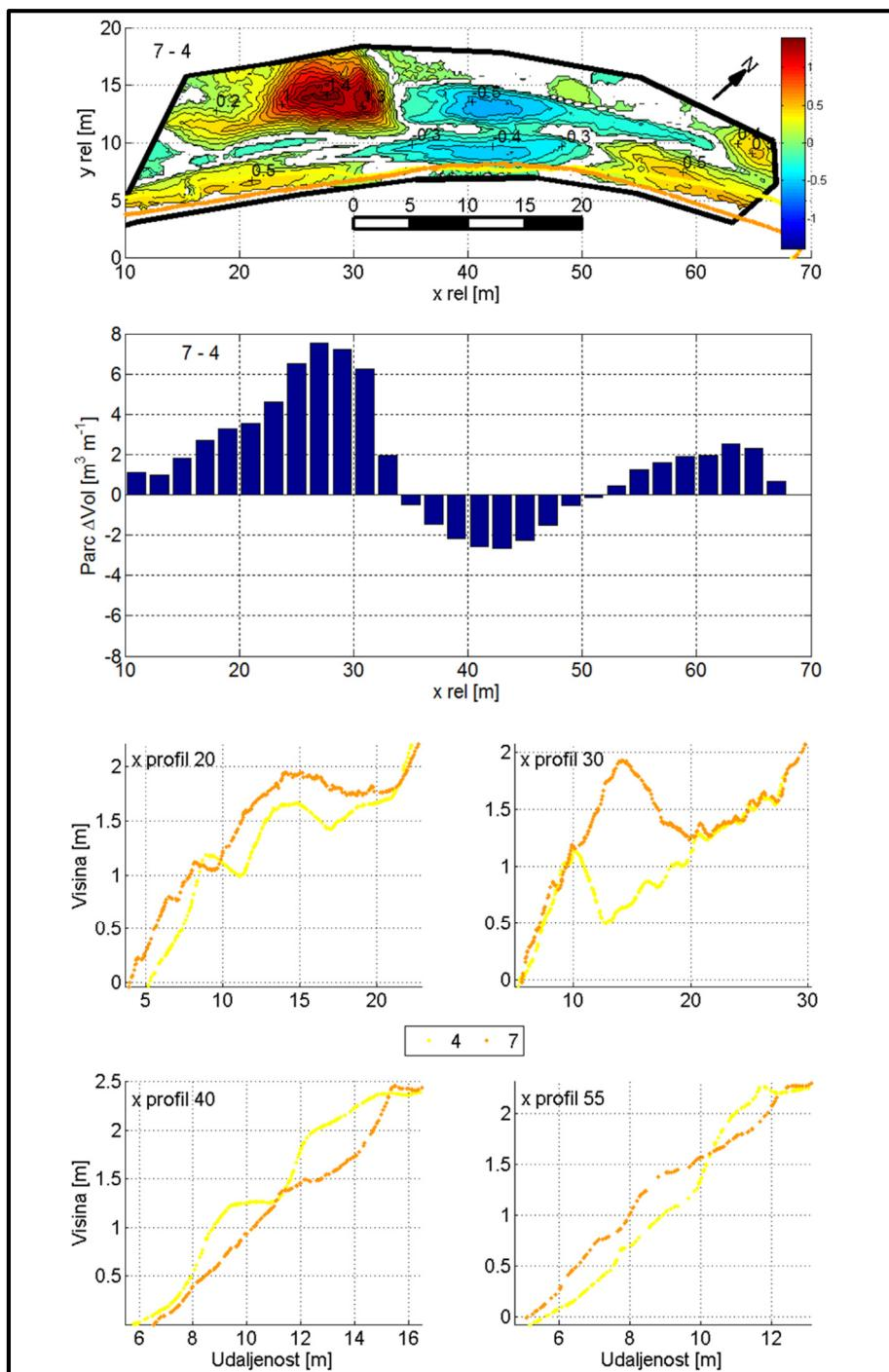
Slika 7.8. Promjene žala Uboka između mjerjenja 4 (24.1.) i 7 (14.2.); A - promjene visina žala; B - parcijalne promjene volumena žala; C - poprečni presjeci žala
