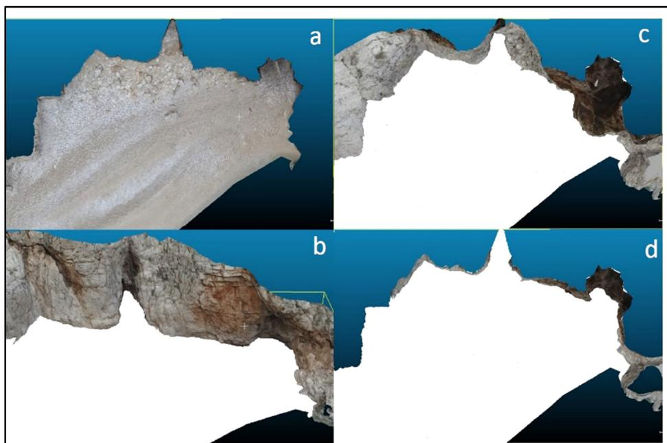
**Slika 5.18. Trodimenzionalni oblak točaka žala. a – oblak točaka tijela žala; b – ortogonalni prikaz oblaka točaka žala (bijelo) i okonih stijena; c – tlocrtni prikaz žala i okonih stijena presjek na 7 m n.m.(c) i 2 m n.m.(d)**
