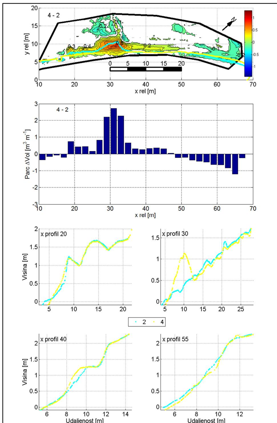
Slika 7.7. Promjene žala Uboka između mjerjenja 2 (5.1.) i 4 (24.1.); A - promjene visina žala; B - parcijalne promjene volumena; C - poprečni presjeci žala
