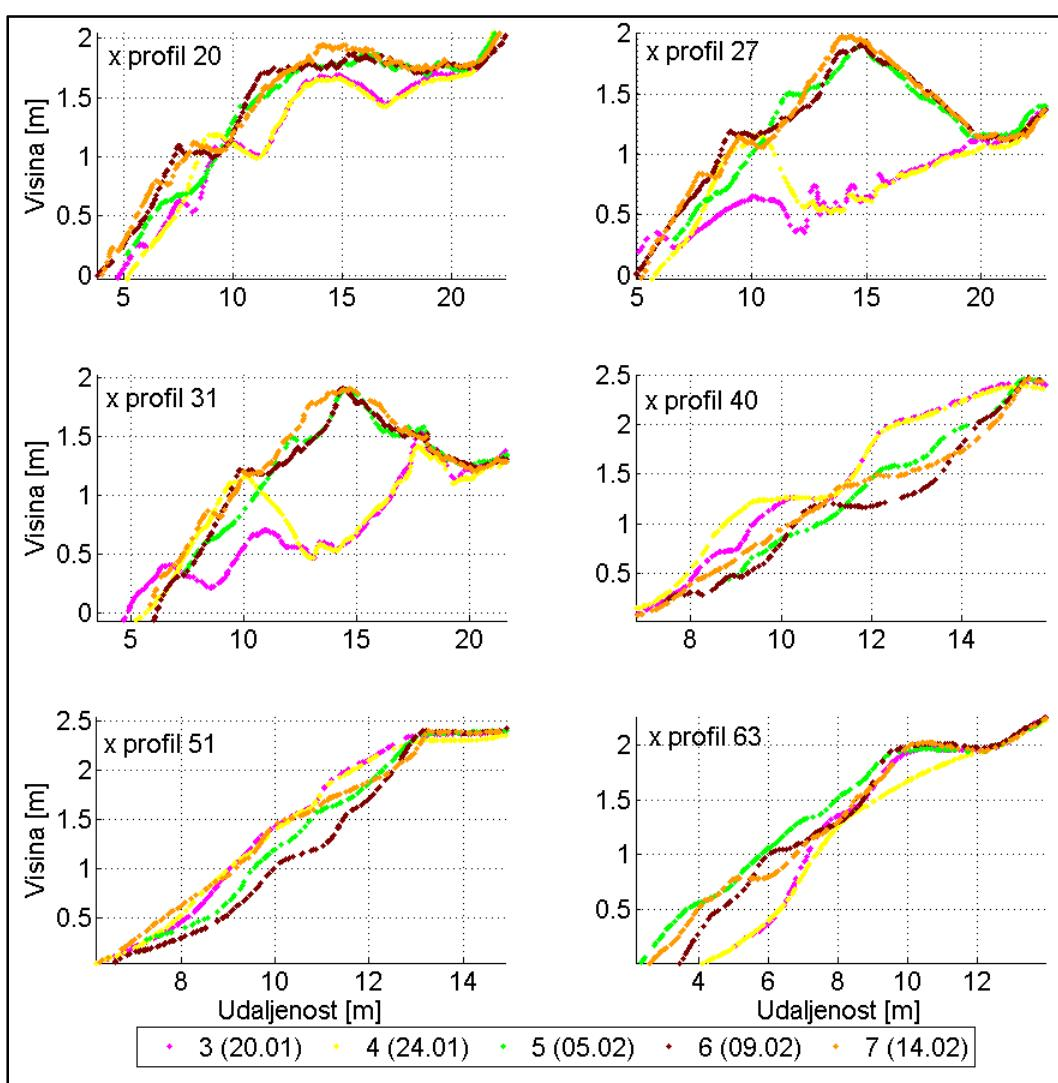
Slika 7.12. Karakteristični poprečni presjeci žala od mjerena br. 3(20.1.) do 7(14.2.)
