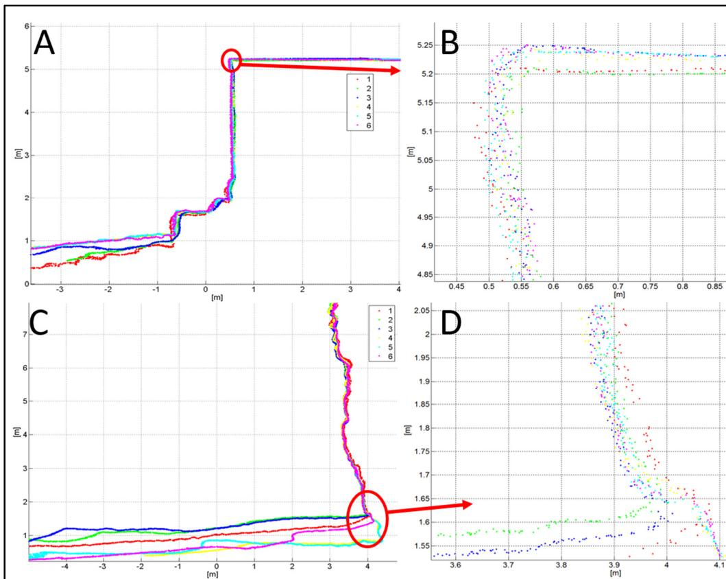
Slika 5.13. Poprečni presjeci derivirani iz oblaka točaka nakon primjene ICP algoritma. A – poprečni presjek s prikazanim detaljem na objektu (B); C – poprečni presjek s prikazanim detaljem na granici stijene i žala (D)
