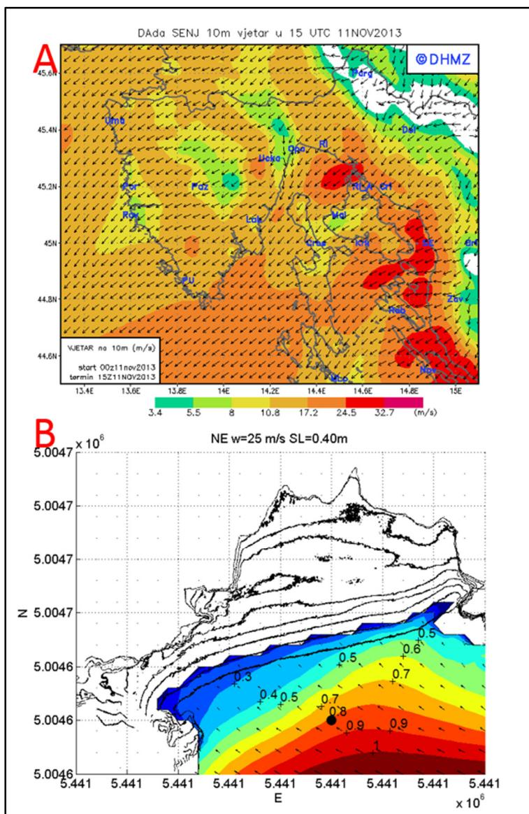
**Slika 6.16. Polje vjetra prognozirano modelom Aladin (A – 11.11.), Rezultati numeričke simulacije značajne visine vala (SWAN) ispred žala Klančac sa prikazanim slojnicama mjerena br. 3.**
