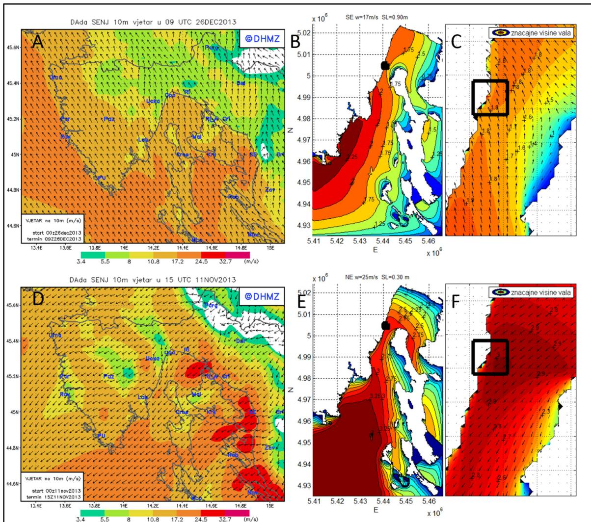
**Slika 6.4. Numerička simulacija valova SE (jugo) i NE (bura) vjetra. A – C: jugo, 26.12.2013.; D – F: bura, 11.11.2013.; Prognozirano polje vjetra modela Aladin - DHMZ (A,D); Numeričke simulacije valova Kvarnera i Riječkog zaljeva (B,E), te detalji oko Brseča (C,F)**
