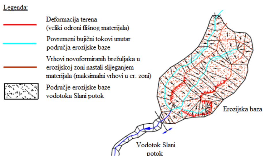
Slika 4.15. Prikaz bujičnog vodotoka Slani potok i erozijske baze za potrebe izrade računalnog koda u SOLFEC simulacijskom programu (Žic i sur., 2012b, 2012c)
