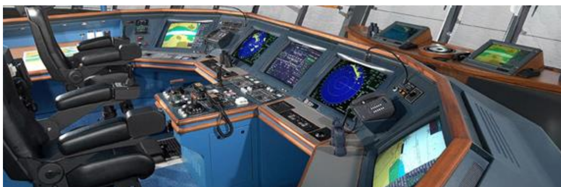
Slika 70. Prikaz zapovjedničkog mosta s NSS-om
