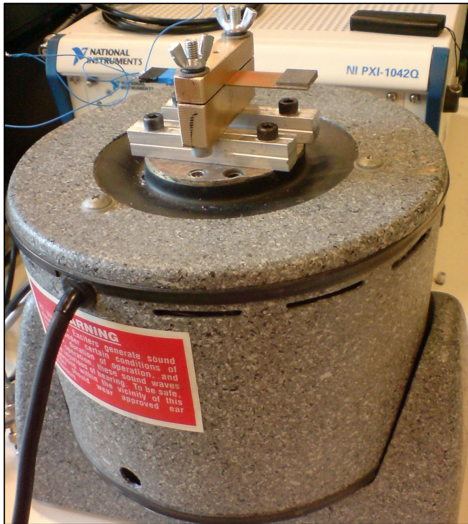
Slika 90. Uklještena piezoelektrična konzola s utegom na slobodnom kraju postavljena na elektromagnetski vibracijski uzбудnik MB Dynamics PM25A
