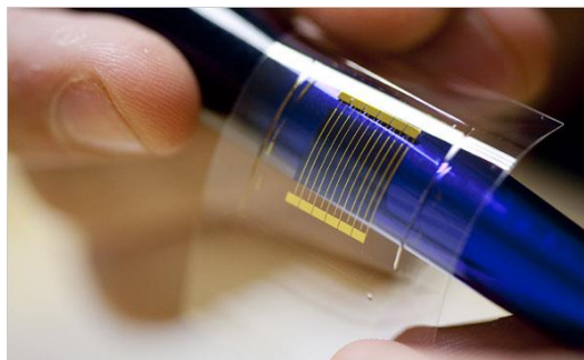
Slika 6. Fleksibilna tanka solarna ćelija [URL: Ecofriend]
