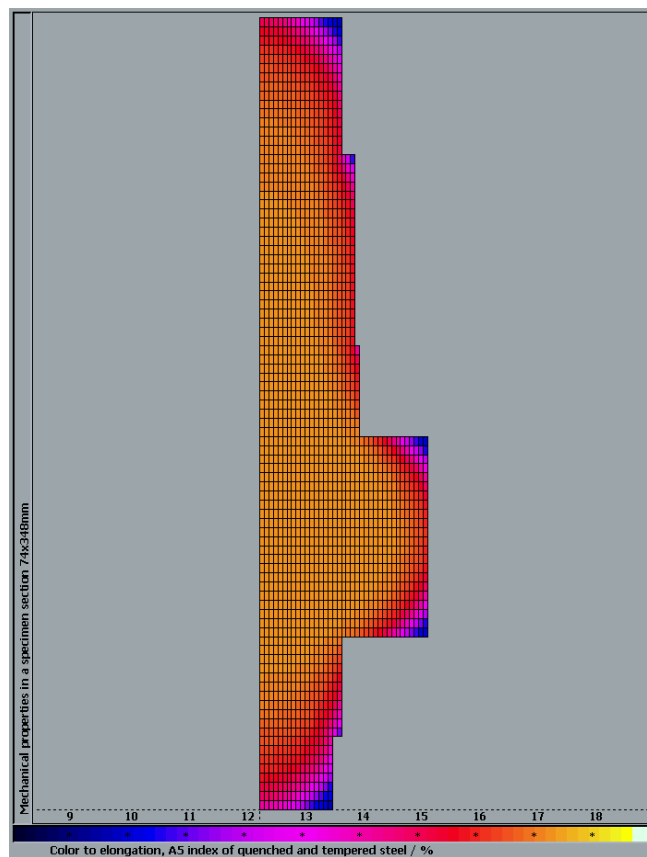
Slika 4.59. Raspodjela vrijednosti istezljivosti u poboljšanoj čeličnoj osovini
