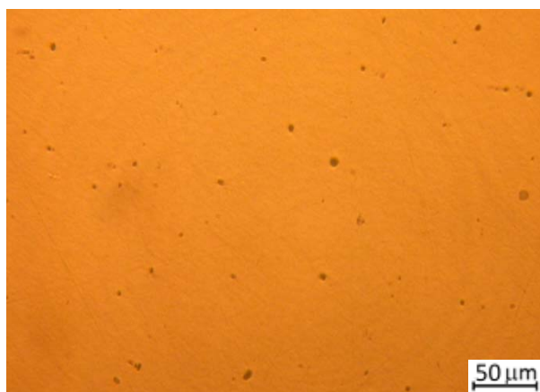
Slika 4.28. Metallografski snimak uzorka 2 nakon poboljšavanja, nenagrizano, polirano, 200:1
