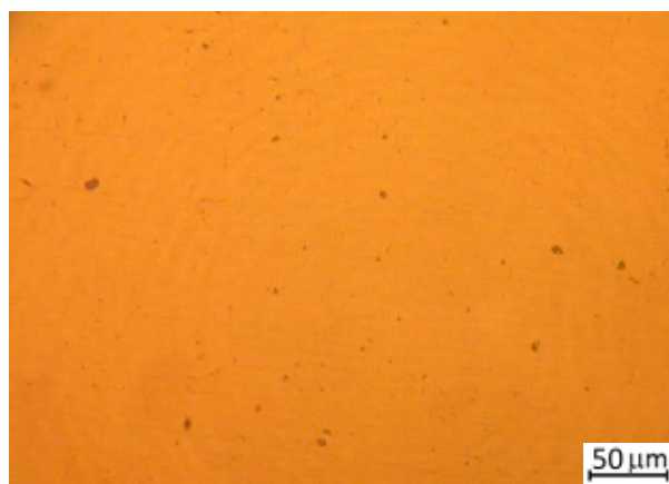
Slika 4.51. Metallografski snimak uzorka 8 nakon poboljšavanja, nenagrizano, polirano, 200:1
