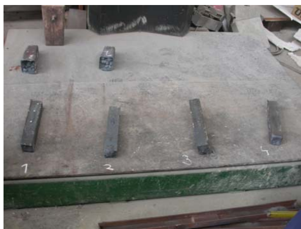
Slika 4.12. Gredice neposredno nakon lijevanja
