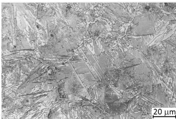
Slika 2.4. Karakteristična mikrostruktura perlita i sekundarnog cementita, 500:1
