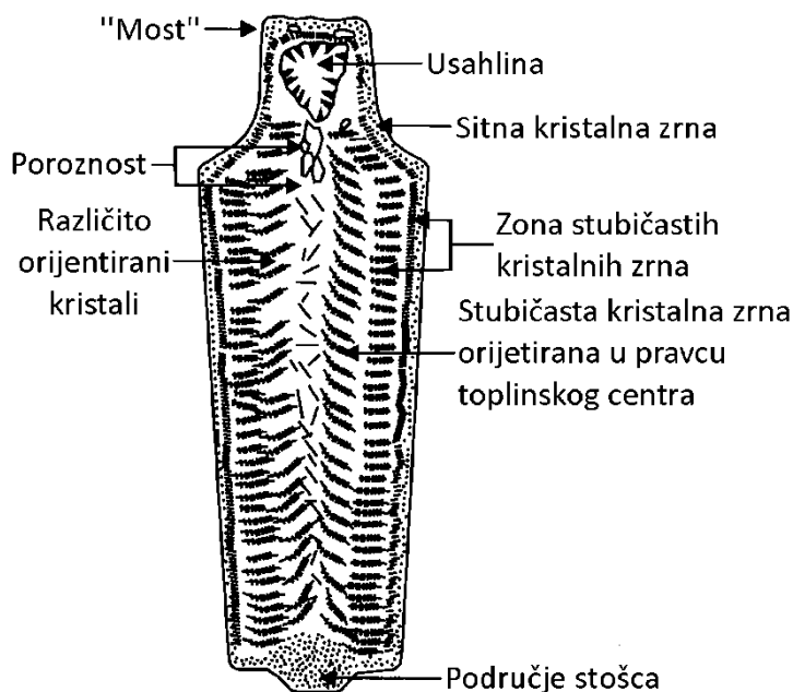
Slika 3.8. Shematski prikaz presjeka ingota
