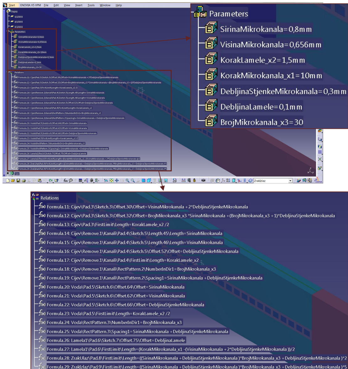
Sl. 3.6. Ispis zaslona primijenjenog računarskog programa s detaljnim prikazom svih geometrijskih parametara
