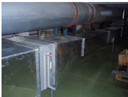
Sl. 4.2. Ispitna zona (a) i lijeva strana s kolektorskim priključcima (b) ispitivanog cijevnog lamelnog izmjenjivača topline
