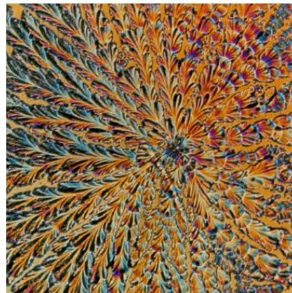
*Il. 15 – Unakrsno polarizirana optička mikro-fotografija supermolekule nastale u vodi od amfilfiličnih linearno-dentričkih kopolimera*
