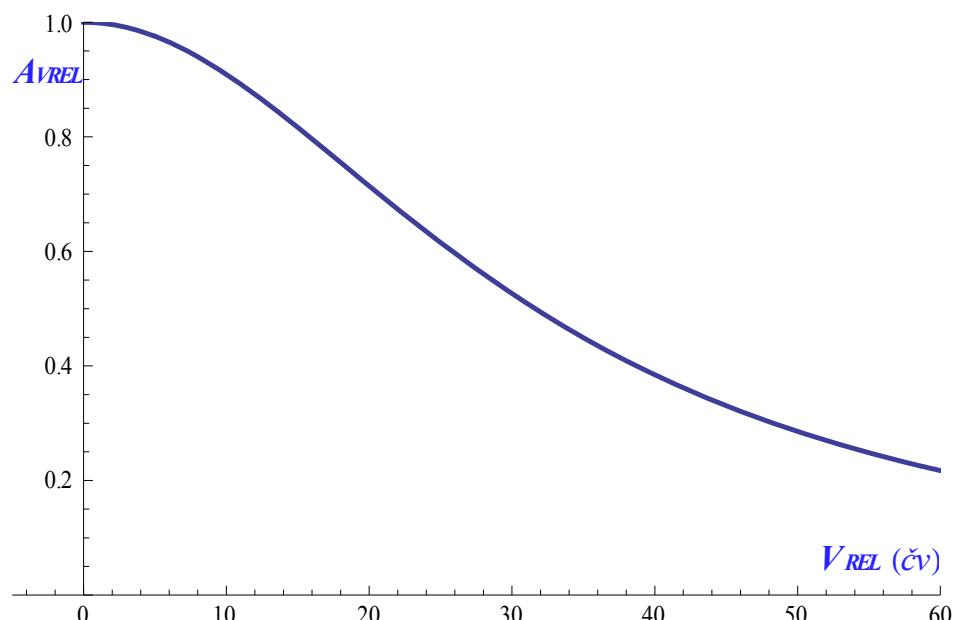
**Slika 20 Utjecaj relativne brzine na funkciju povećane opasnosti uz prepostavljeni konstantni koeficijent korekcije relativne brzine**
