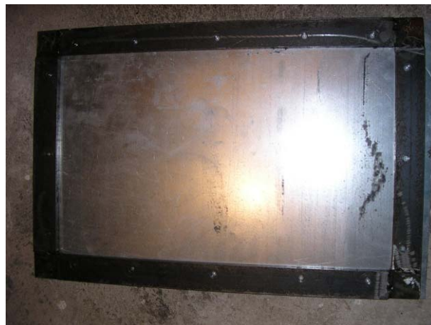
Slika 4.7. Okvir za vanjski rub panela
