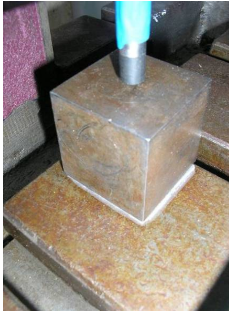
Slika 4.15. Prikaz mjerenja prigušenja u brtvi
