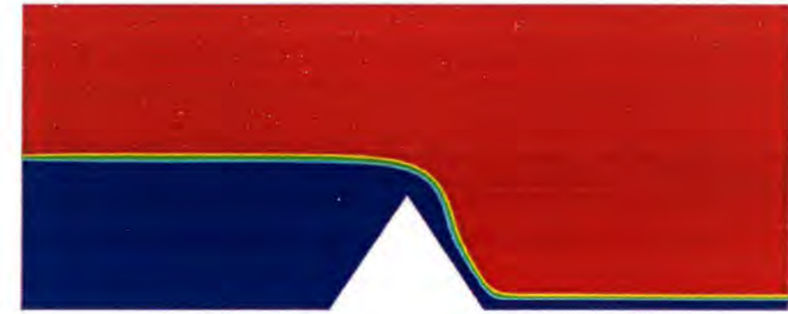
Slika 4.10. Distribucija faza (voda-zrak) u osi kanala
