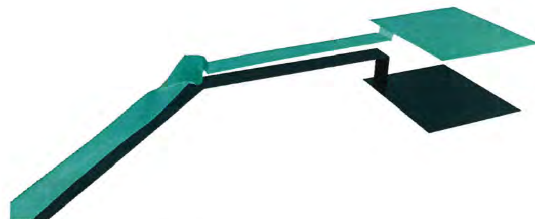
Slika 4.18. Poplavljenost cijelog kanala i formiranje povratnog vala ( t = 5 s) u 2D modelu
