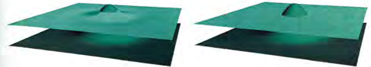
Slika 3.7. Proračunato vodno lice bez ispravnog balansiranja na unutarnjoj granici (lijevo) i sa ispravnim balansiranjem na unutarnjoj granici (desno)
