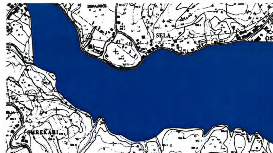
Slika 5.31. Poplavna linija rijeke Čabranke za 1000-godišnji povratni period na dionici od sela Zamost do Osilnice
