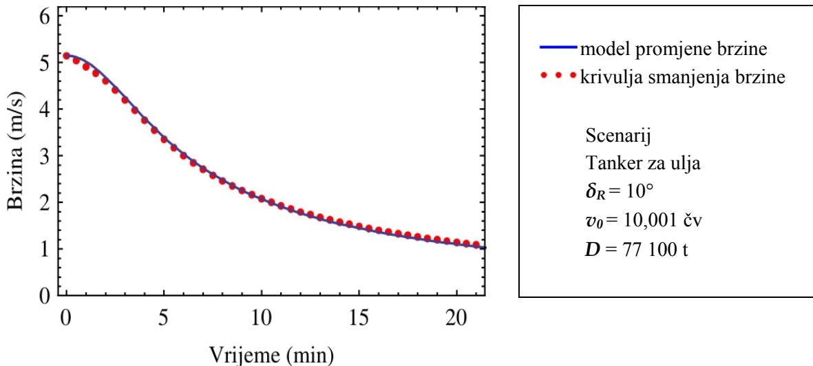
Slika 36. Postignuto poklapanje modela promjene brzine sa simuliranim funkcijom brzine
