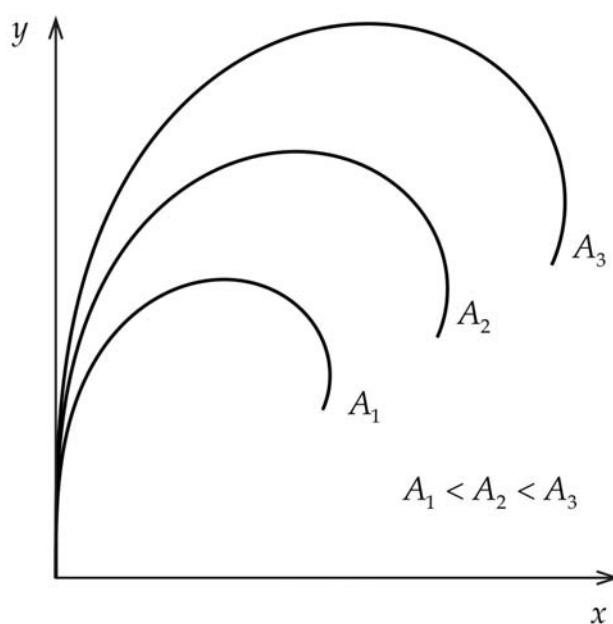
Slika 33. Geometrijski slične klotoide ovisne o parametru  $A$
