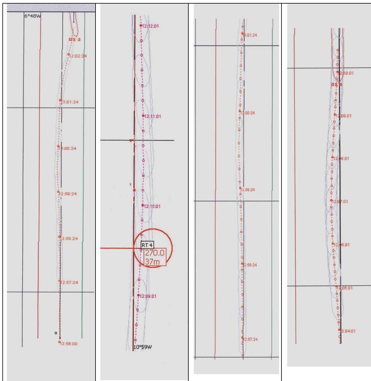
Slika 12. Grafički ispis simulacija kretanja broda na navigacijskom simulatoru Transas NTPro 4000 za različite brodove
