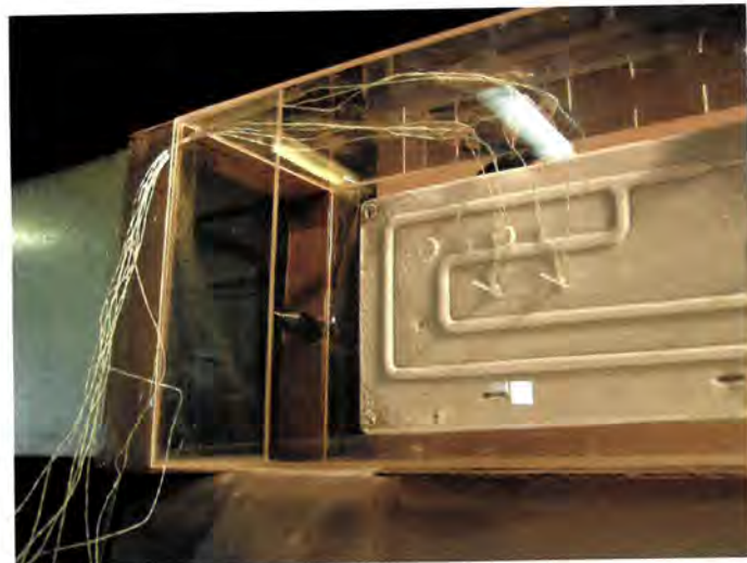
Slika 6.3. Položaj osjetnika temperature, vlažnosti i brzine zraka te polja termoparova u ispitnoj zoni zračnog tunela
