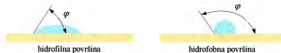
Slika 8.32. Prikaz dodirnog kuta hidrofilnih i hidrofobnih površina
