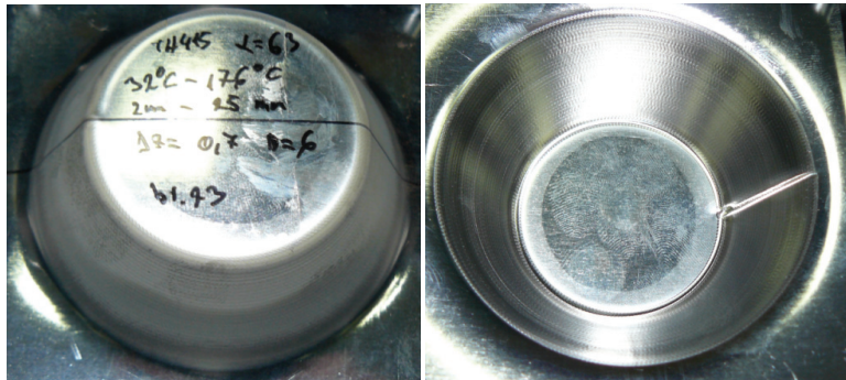
Slika 8.13 Prikaz izratka kut 63^\circ , lim TH415
