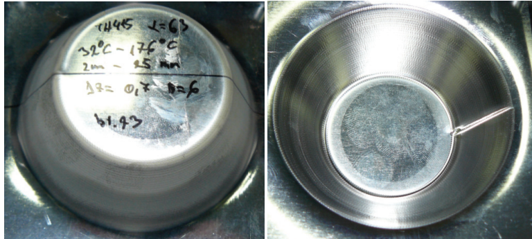
Slika 8.13 Prikaz izratka kut 63^\circ , lim TH415
