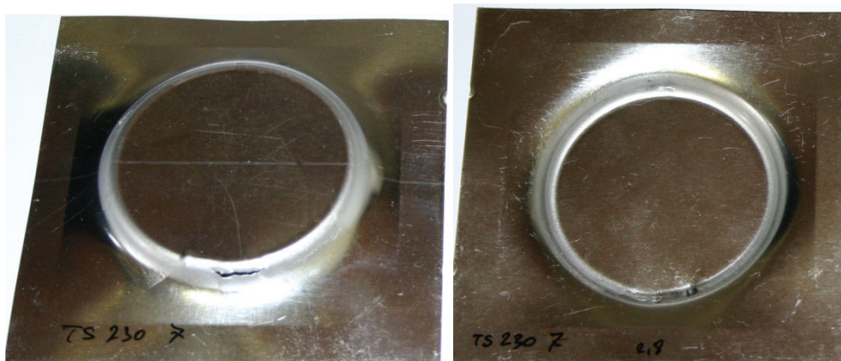
Slika 8.16 Uzorak TS230 - 7, kut 60° visina 7 mm
