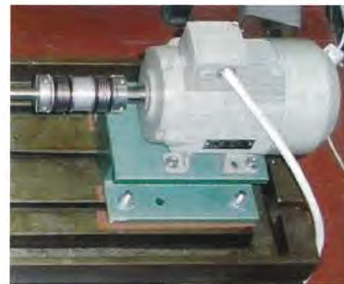
Slika 5.7. Spoj rotora s elektromotorom preko elastične spojke
