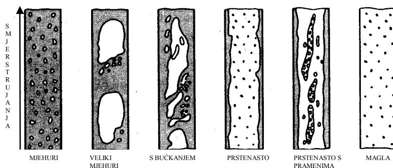
Slika 3.5. Režimi uzlaznog strujanja u vertikalnoj cijevi
