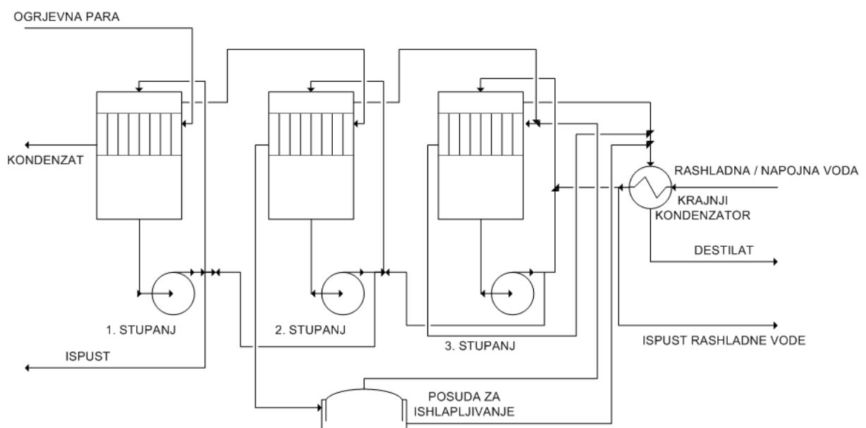
**Slika 2.11.** Višestupanjski uređaj s protusmjernim napajanjem
