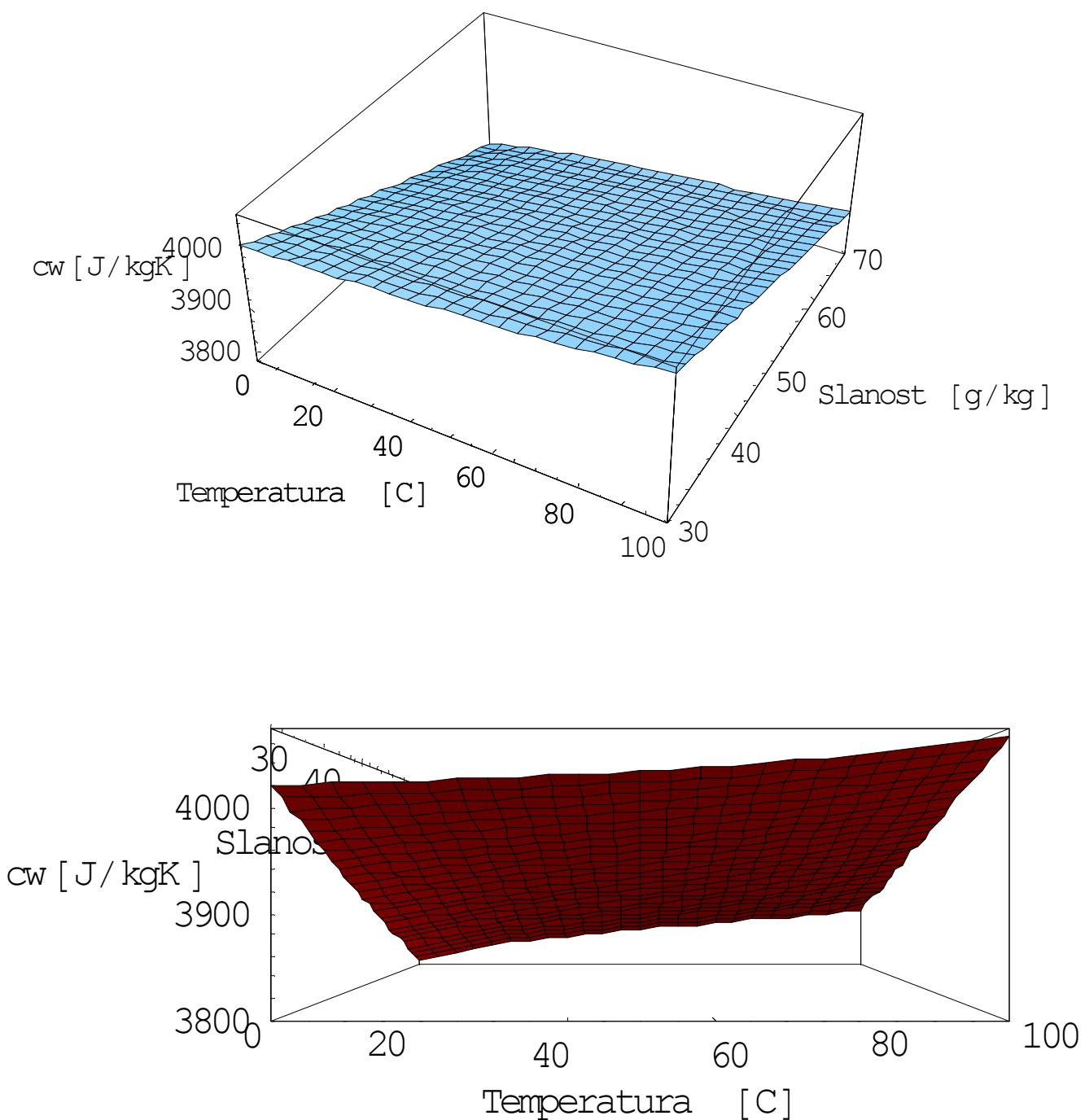
**Slika 4.31.** Trodimenzionalni prikaz ovisnosti specifičnog toplinskog kapaciteta slane otopine o temperaturi i slanosti
