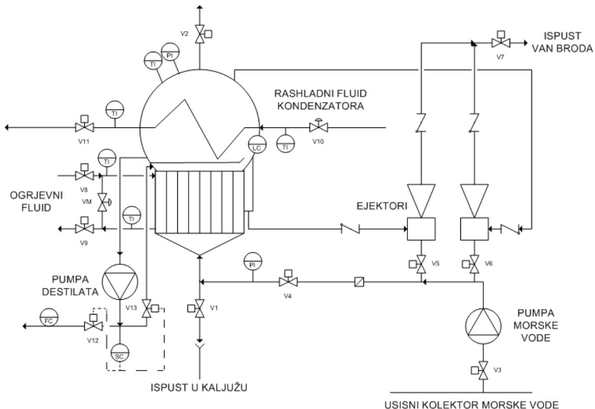
**Slika 5.14.** Shema destilacijskog uređaja s uobičajenim postavom mjernih instrumenata
