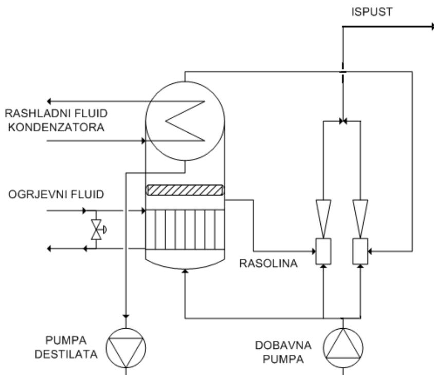
**Slika 2.12.** Jednostupanjski uređaj s uronjenim ogrjevnim elementom
