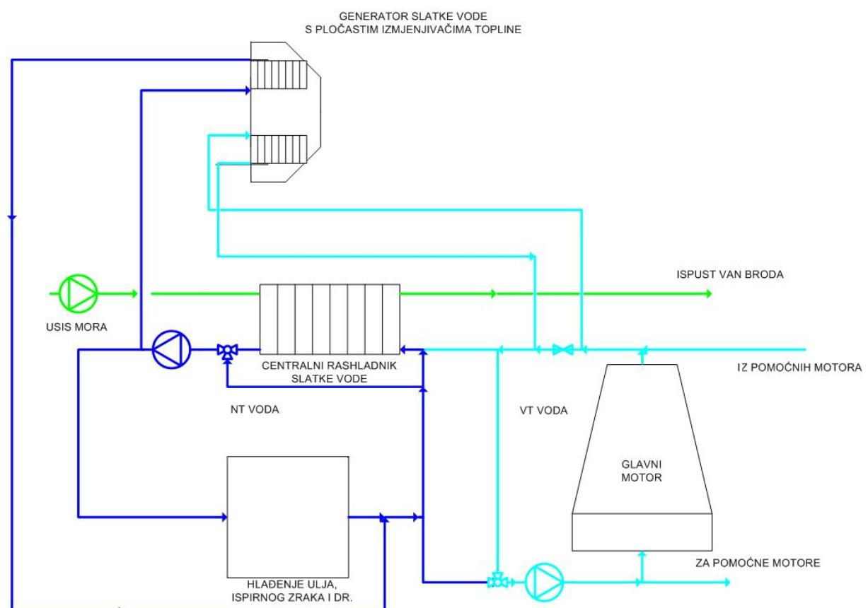
Slika 2.30. Kondenzator destilacijskog uređaja hlađen niskotemperaturnom slatkom vodom
