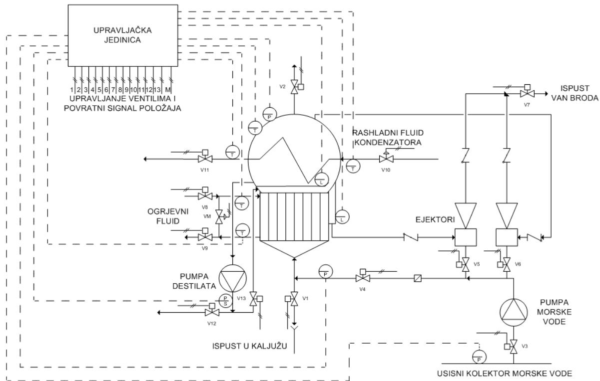
**Slika 5.17.** Shema destilacijskog uređaja s daljinskim automatskim upravljanjem
