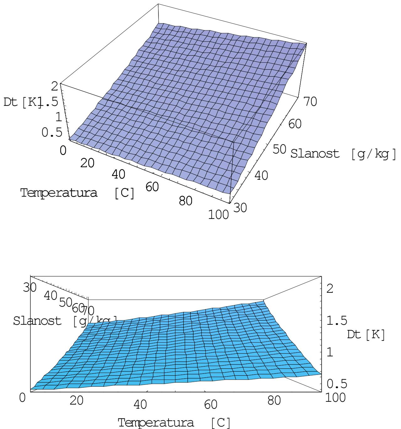
**Slika 4.33.** Trodimenzionalni prikaz ovisnosti povišenja temperature zasićenja morske vode u odnosu na slatkiju vodu istog tlaka o temperaturi i slanosti
