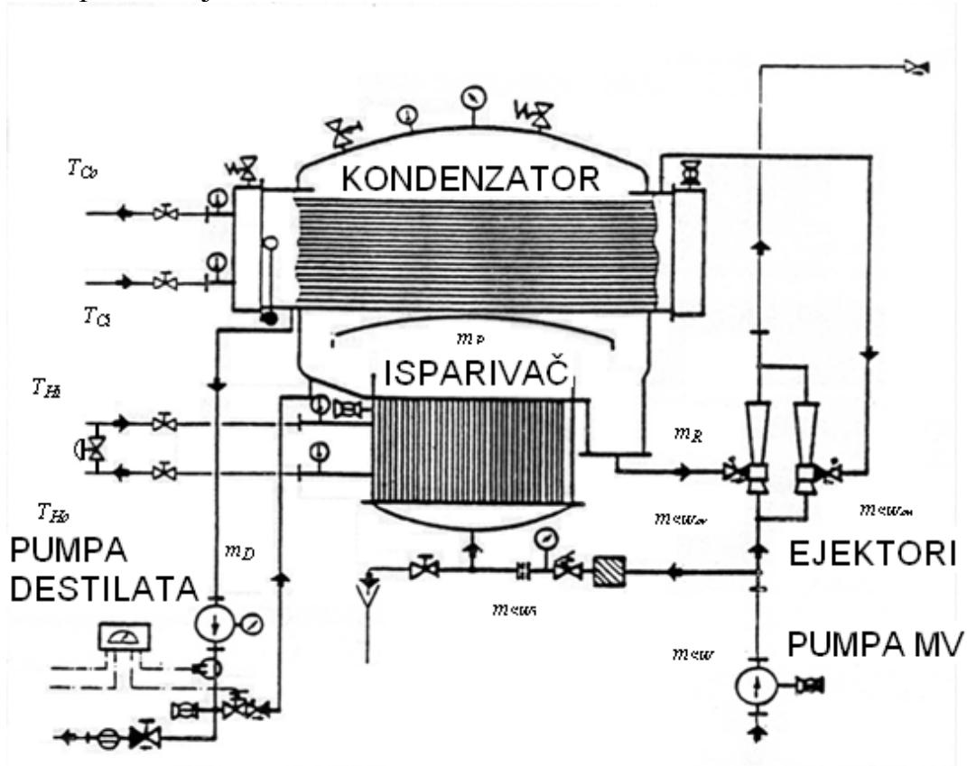
Slika 3.1. Shema jednostupanjskog vakuumskog generatora slatke vode
