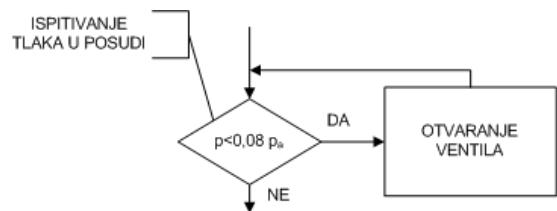
**Slika 5.16.** Dijagram toka funkcije kontrole tlaka i puštanja zraka u posudu u slučaju preniskog tlaka
