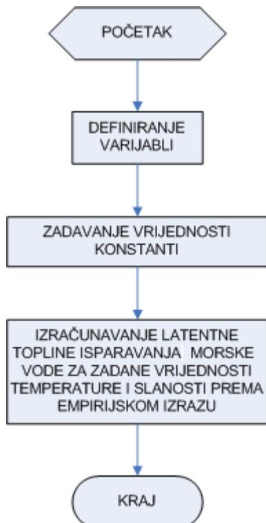
**Slika 4.3.** Blok dijagram potprograma za određivanje latentne topline isparavanja morske vode
