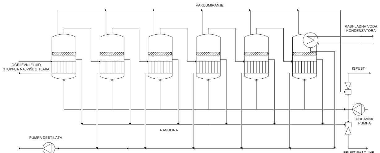
**Slika 2.13.** Višestupanjski uređaj s uronjenim ogrjevnim elementom
