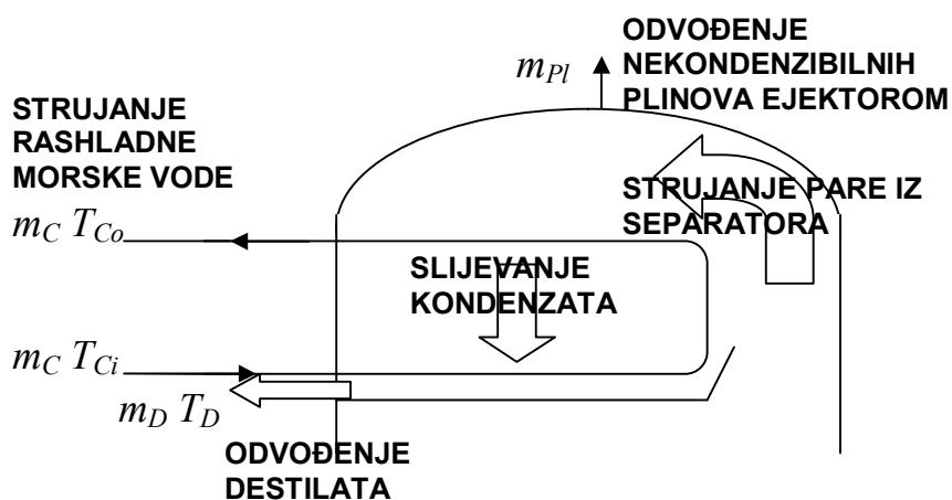
Slika 3.8. Shematski prikaz strujanja u cijevnom kondenzatoru
