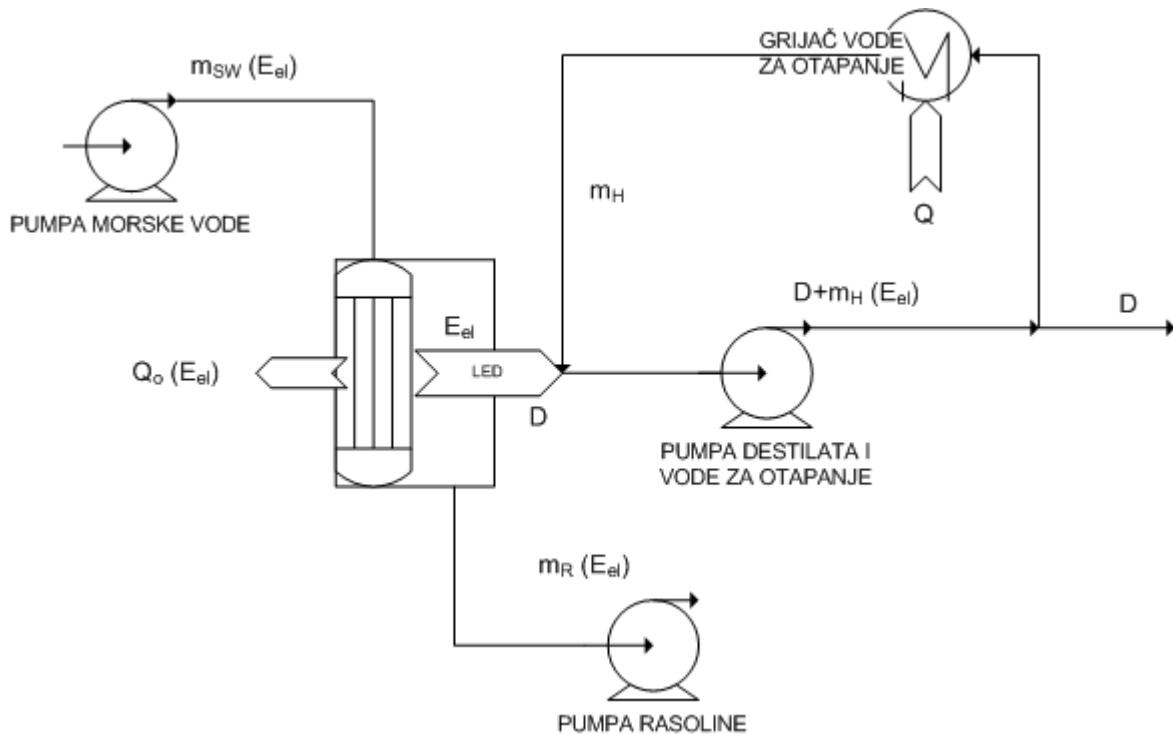
**Slika 2.6.** Prikaz procesa proizvodnje slatke vode metodom zamrzavanja
