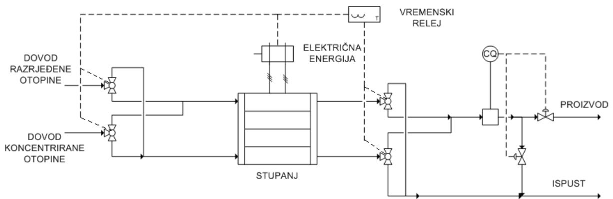
Slika 2.4. Izvedba s promjenjivim smjerom električne struje
