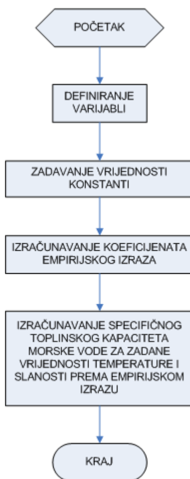
Slika 4.5. Blok dijagram potprograma za određivanje specifičnog toplinskog kapaciteta morske vode
