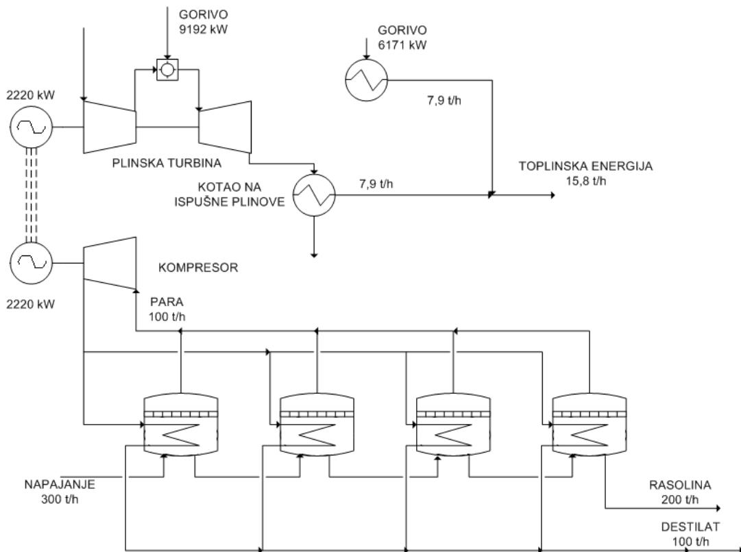
**Slika 2.23.** Kogeneracijsko postrojenje s plinskom turbinom i četverostupanjskim destilacijskim uredajem s rekompresijom pare
