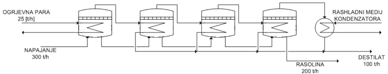
Slika 2.19. Četverostupanjski destilacijski uređaj
