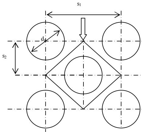
**Slika 3.9.** Geometrija šahovski raspoređenih horizontalnih cijevi, kontrolni volumen pare i kondenzata te njihov smjer strujanja
