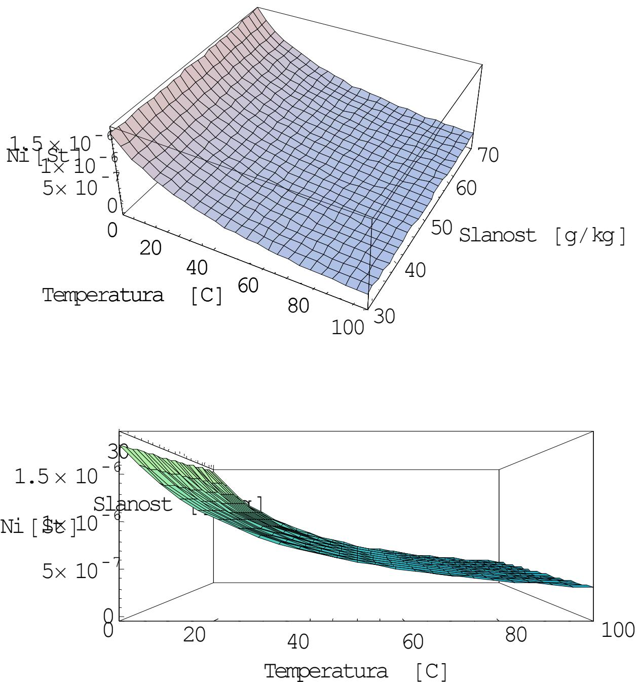
**Slika 4.30.** Trodimenzionalni prikaz ovisnosti kinematičkog viskoziteta o temperaturi i slanosti
