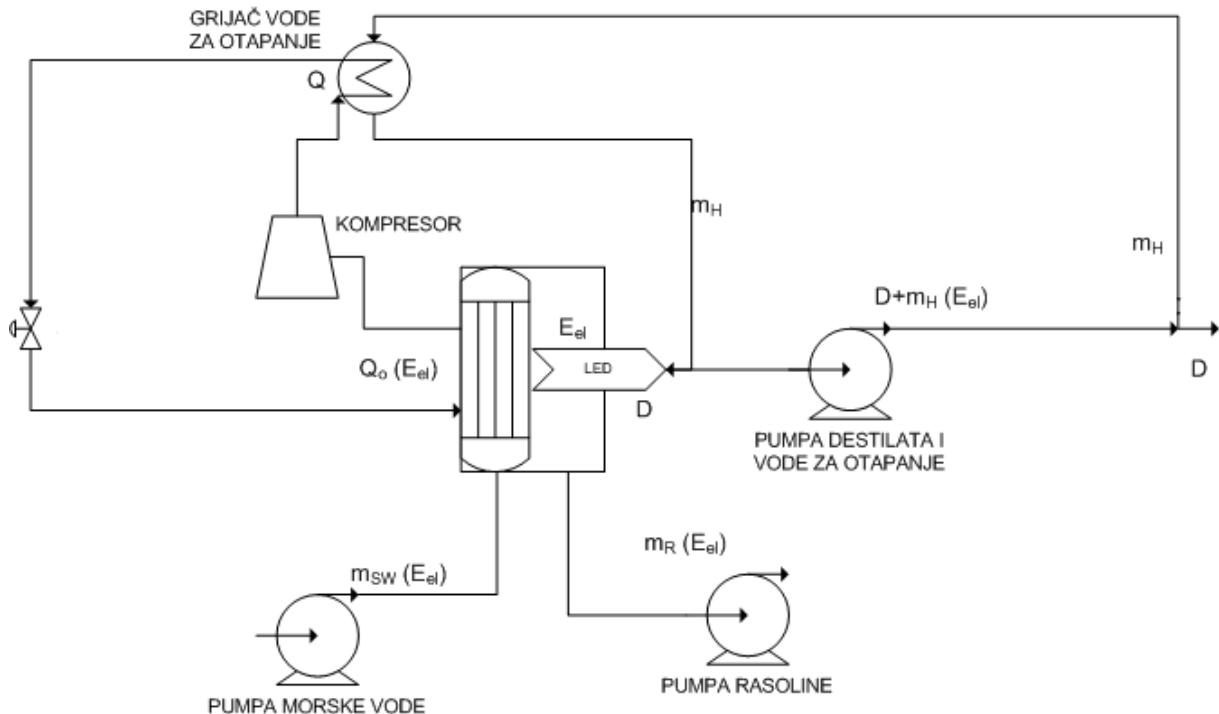
**Slika 2.7.** Prikaz eksnergetski učinkovitijeg procesa proizvodnje slatke vode metodom zamrzavanja
