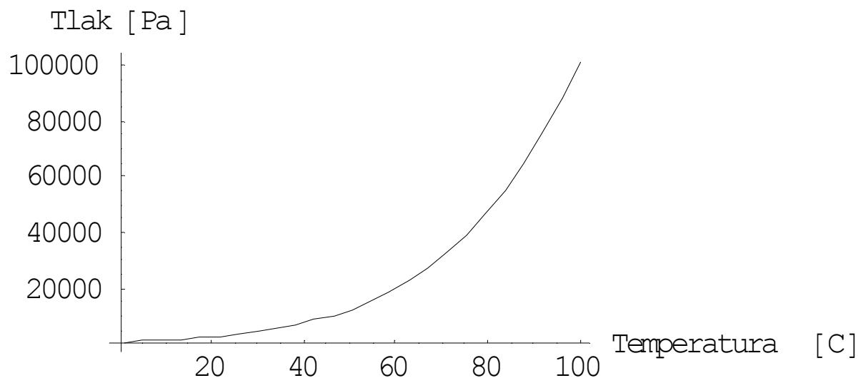
**Slika 4.35.** Prikaz ovisnosti temperature zasićenja slatke vode o tlaku
