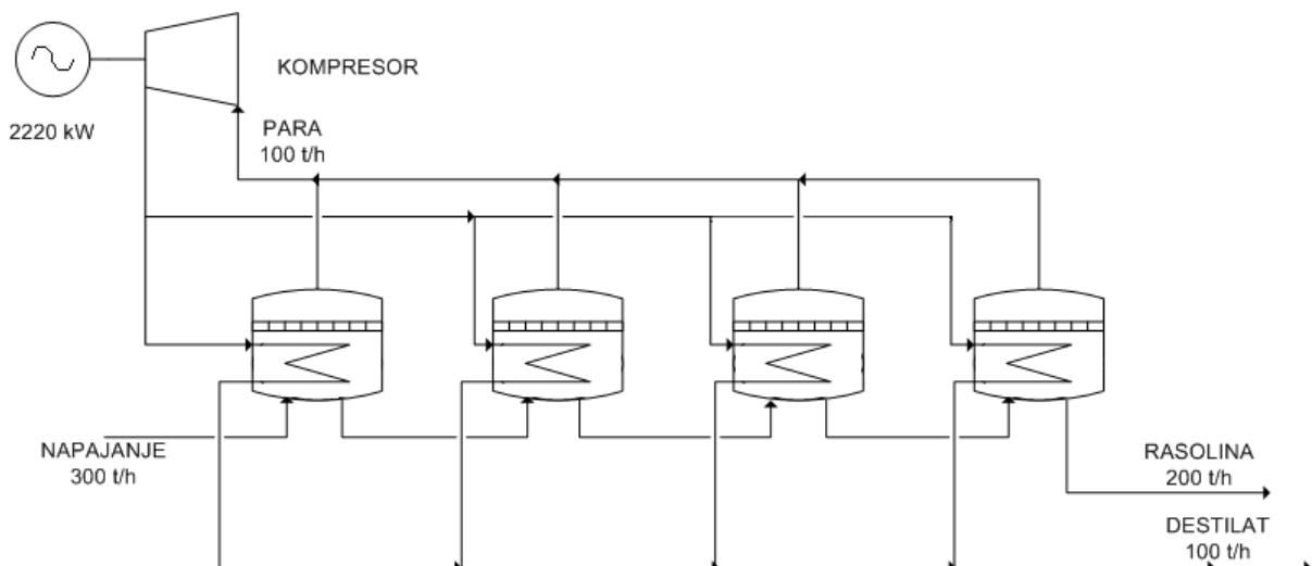
Slika 2.20. Četverostupanjski destilacijski uređaj s rekompresijom pare
