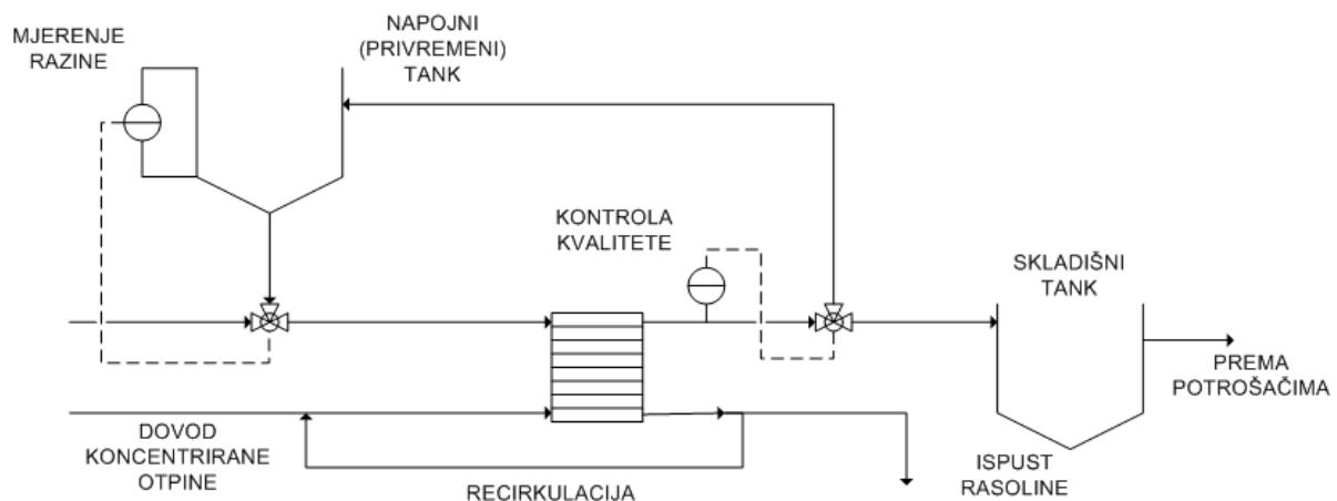
**Slika 2.3.** Naizmjeničan rad elektrokemijskog desalinizacijskog postrojenja
