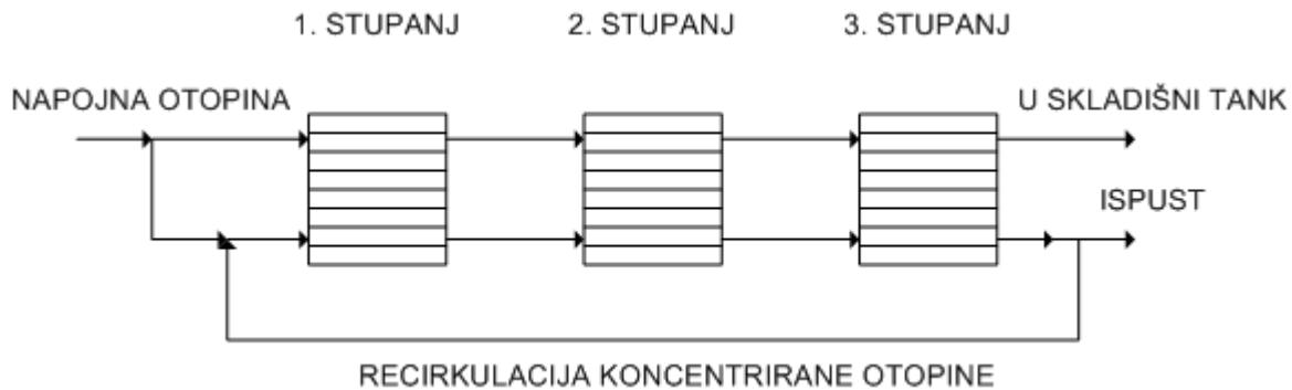
**Slika 2.2.** Kontinuirani rad višestupanjskog elektrokemijskog desalinizacijskog postrojenja
