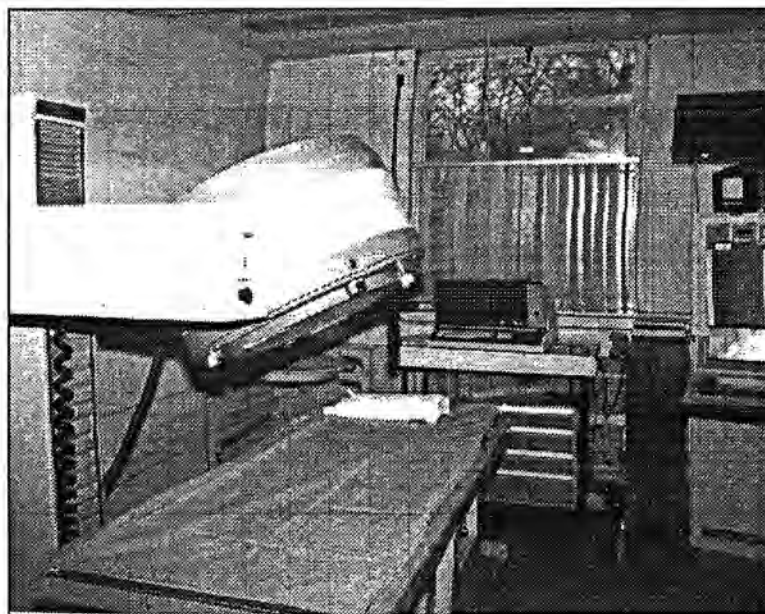
Slika 1. Gama kamera. U prvom planu detektor velikoga vidnog polja.
