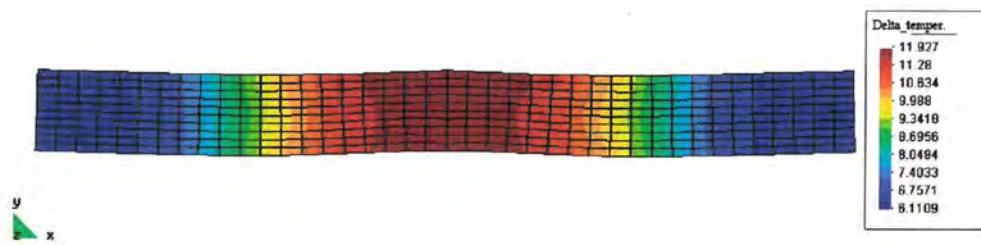
Sl. 8.39. Porast temperature na kraju procesa deformiranja
