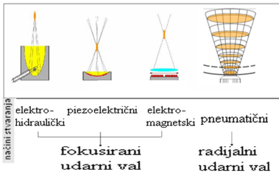
Slika 3. Načini stvaranja udarnog vala
