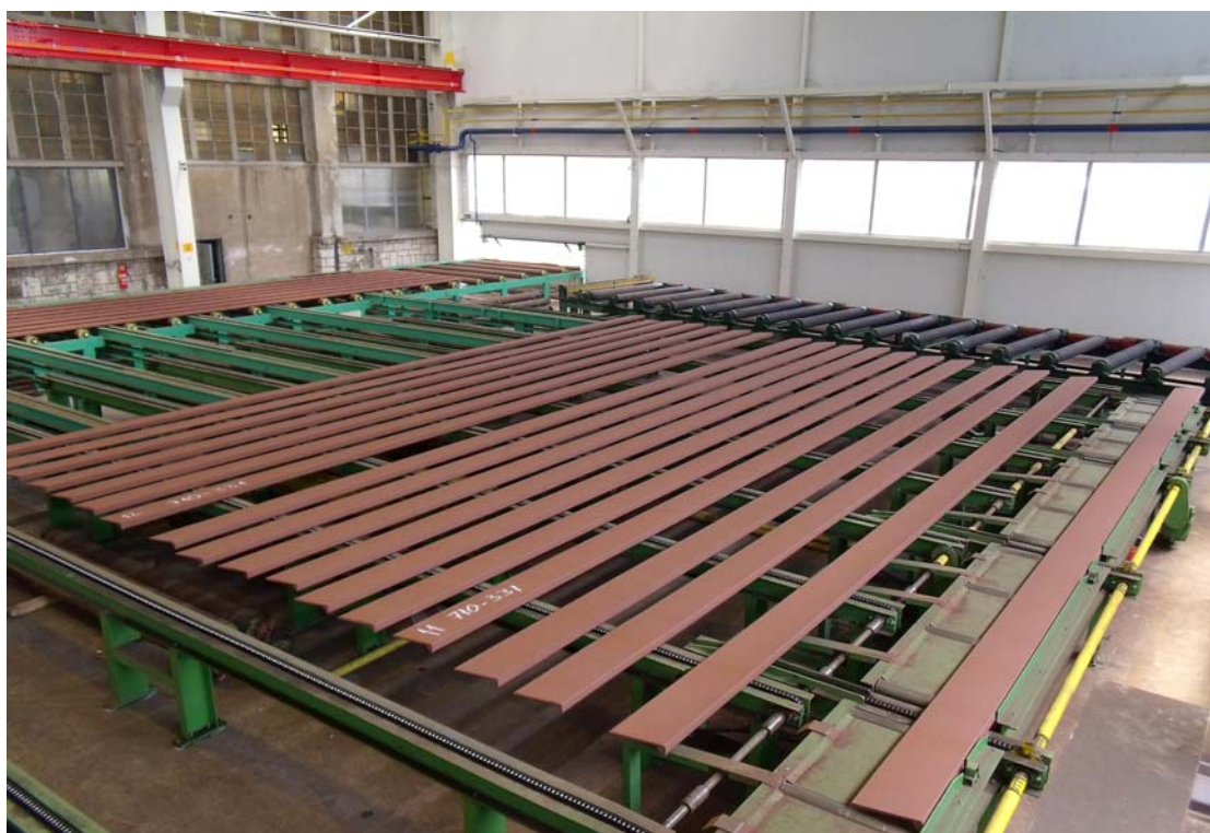
Slika P5.2 Prikaz dijela linije na kojoj se vide bankate profila na ulaznom međuskладиštu prije pojedinačnog prelaska na uzdužni valjčasti transporter
