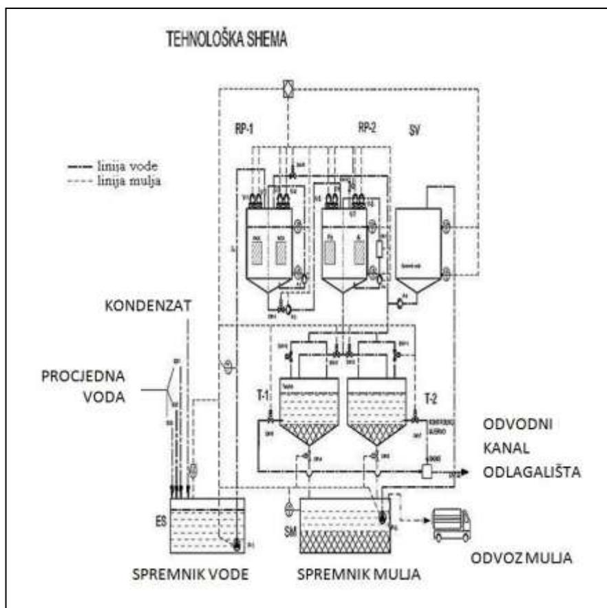
Slika 5.1 Tehnološka shema uređaja za pročišćavanje procjednih voda
