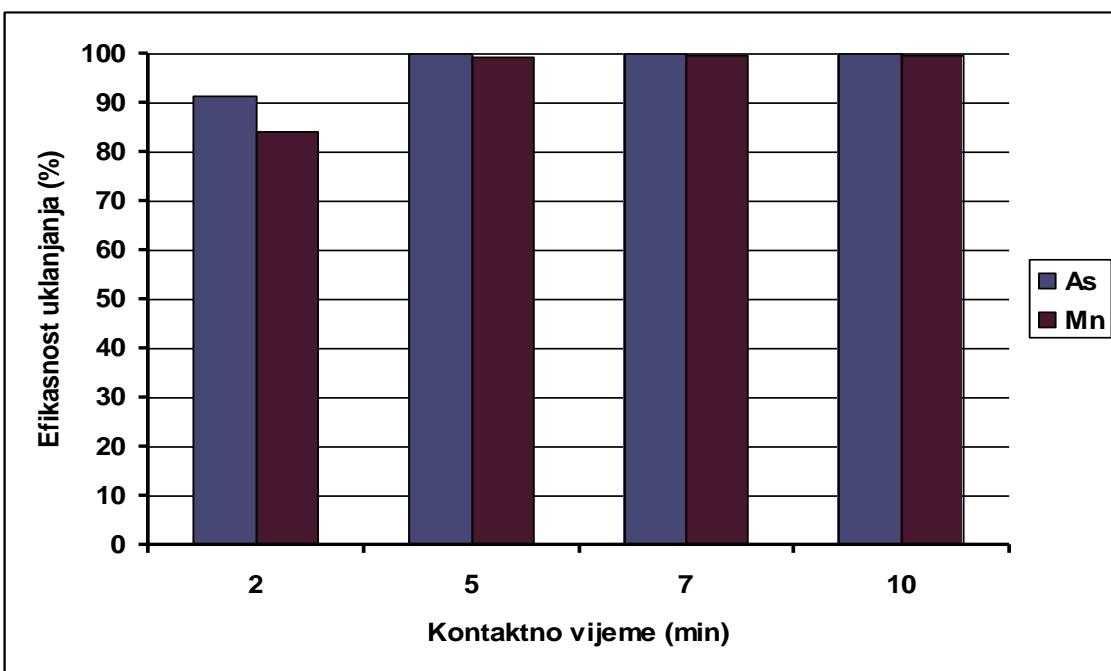
Slika 3.19 Efikasnost uklanjanja arsena i mangana ovisno o kontaktnom vremenu (za jakost struje 40 A; napon 12 V; 10 željezovih elektroda međusobnog razmaka 5 mm, svaka površine  $75 \text{ mm}^2$ )
