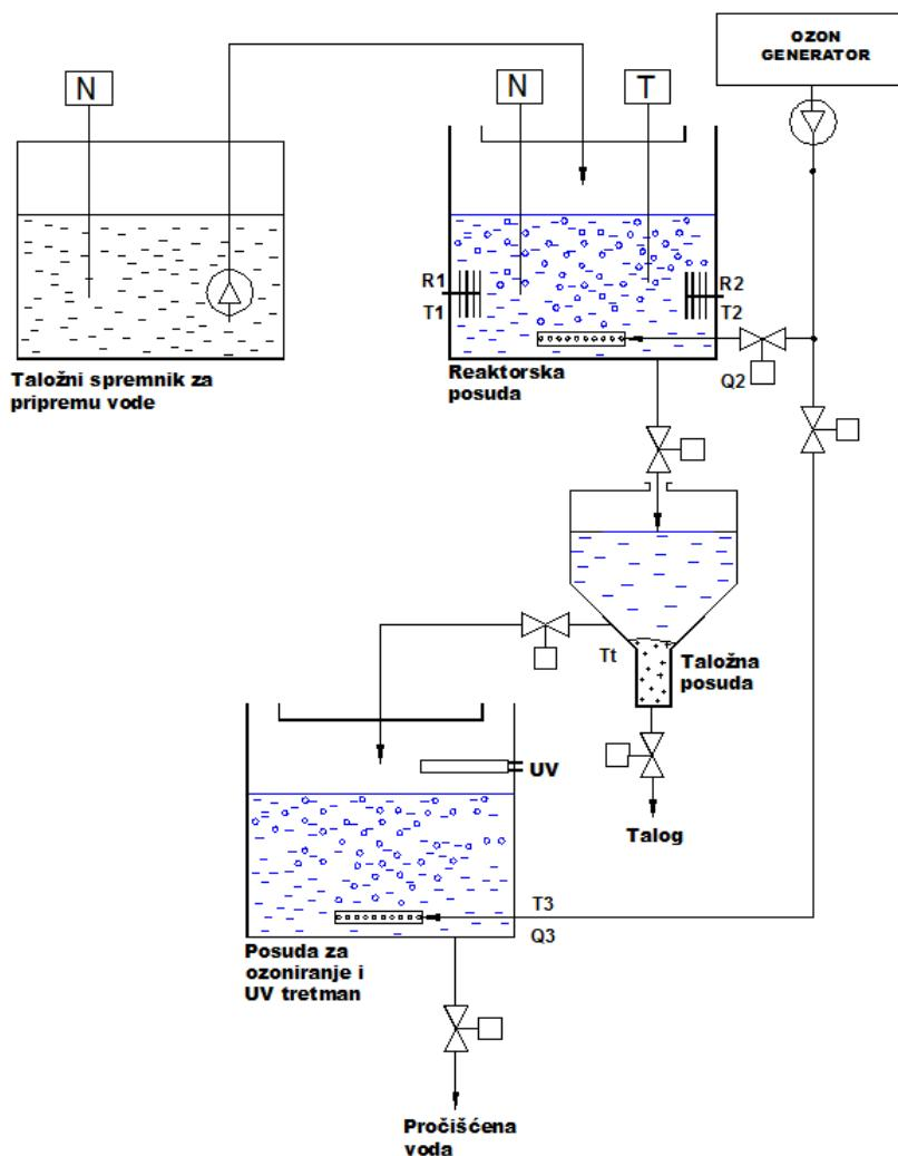
Slika 3.6 Shematski prikaz uređaja za elektrokemijsko pročišćavanje voda
