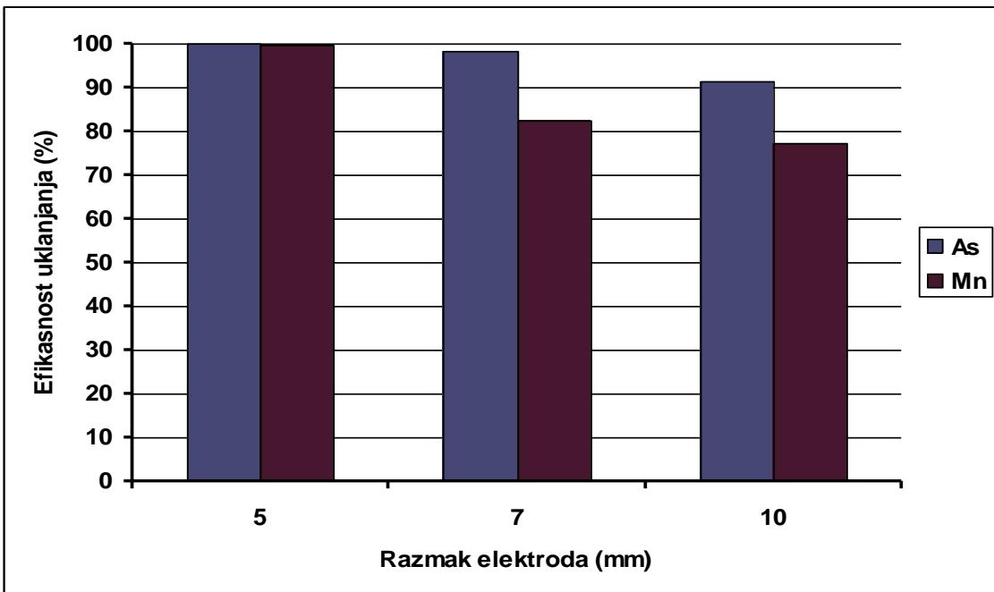
Slika 3.20 Efikasnost uklanjanja arsena i mangana u ovisnosti o razmaku elektroda (za jakost struje 40 A; napon 12 V; kontaktno vrijeme 10 minuta; 10 željezovih elektroda, svaka površine  $75 \text{ mm}^2$ )
