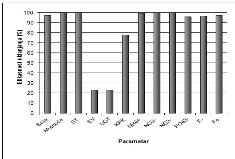
Slika 5.3 Efikasnost uklanjanja parametara u postotcima iz procjednih voda pomiješanih s plinskim kondenzatom nakon kombinirane elektrokemijske obrade
