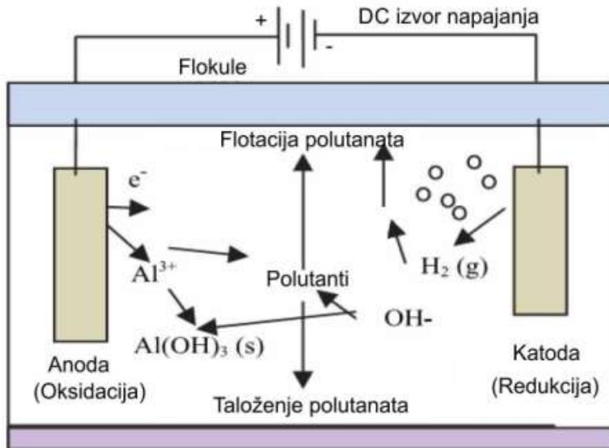
Slika 2.4 Shema bipolarne čelije s procesima izravne i posredne anodne oksidacije [80]
