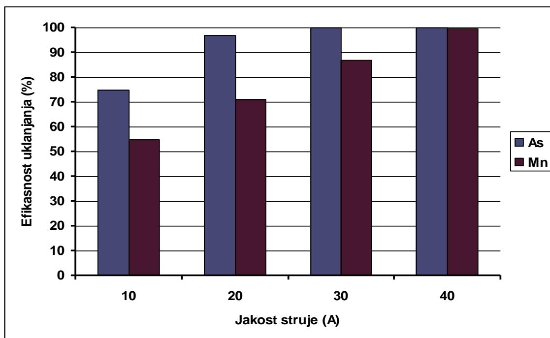
Slika 3.18 Efikasnost uklanjanja arsena i mangana ovisno o jakosti struje (za kontaktno vrijeme od 5 minuta; napon 12 V; 10 željezovih elektroda međusobnog razmaka 5 mm, svaka površine  $75 \text{ mm}^2$ )
