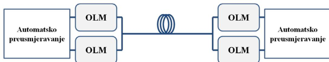
c) Konekcija sa zalihošću linijske opreme i automatskim preusmjeravanjem
