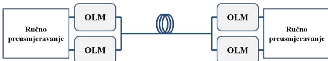
b) Konekcija sa zalihošću linijske opreme i ručnim preusmjeravanjem
