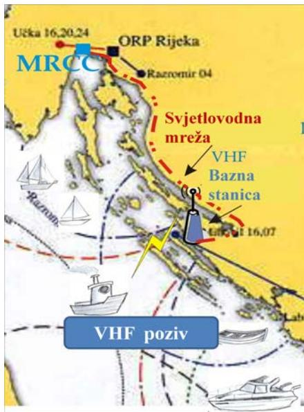
Slika 14: Povezivanje VHF radio-signalata na svjetlovodnu mrežu
