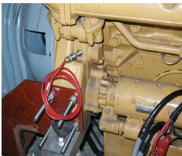
Slika 42: Induktivni senzor za mjerjenje okretaja motora
