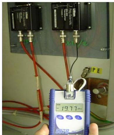
Slika 65: Mjerenje snage svjetlosnog signala
